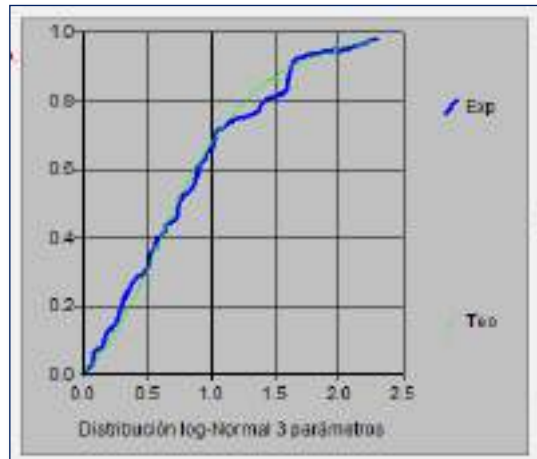
Figura 40: distribución estadística Log Normal con 3 Parámetros Fuente: elaboración propia aplicando Hidroesta 2.0
