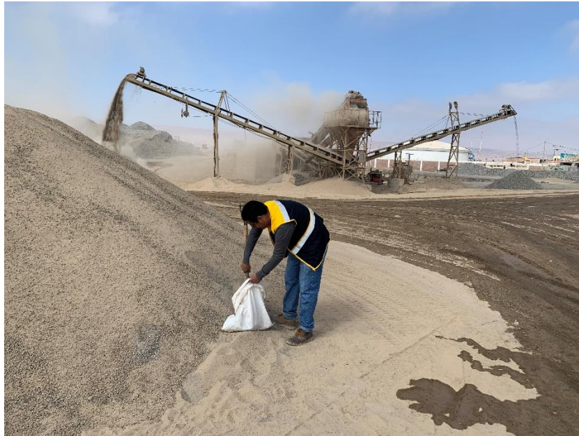
Fotografía 10 Se procedió a retirar la muestra final de la Arena Gruesa, perteneciente a la Cantera de Arunta.
