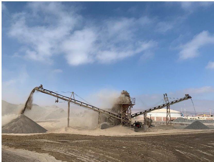
Fotografía 7 La chancadora realiza la trituración de rocas y realiza la clasificación de la Piedra y Arena.
