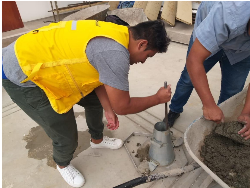
Fotografía 19 Se realizó la Prueba del Slump.
