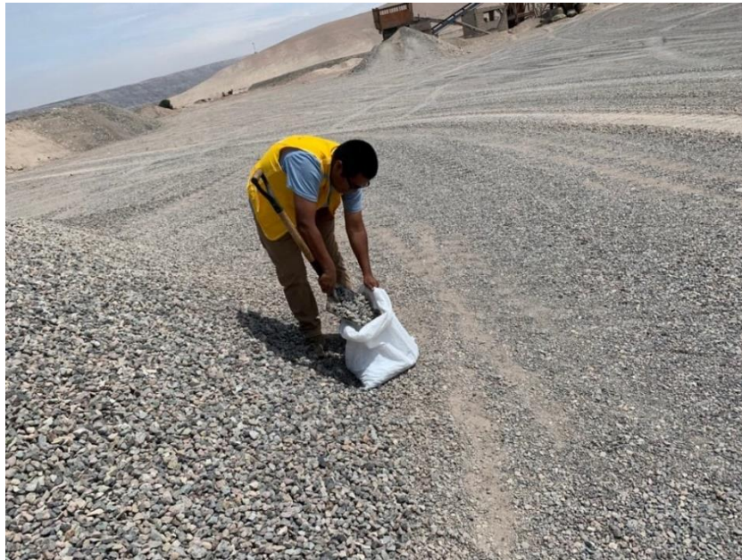
Fotografía 12 Se procedió a retirar la muestra final de la Piedra, perteneciente a las Canteras de Jonas I y Arunta II.
