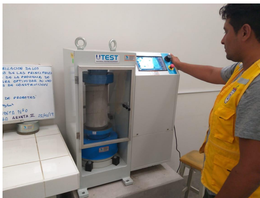
Fotografía 23 Se realizaron los Ensayos de compresión a los 7, 14 y 28 días.
