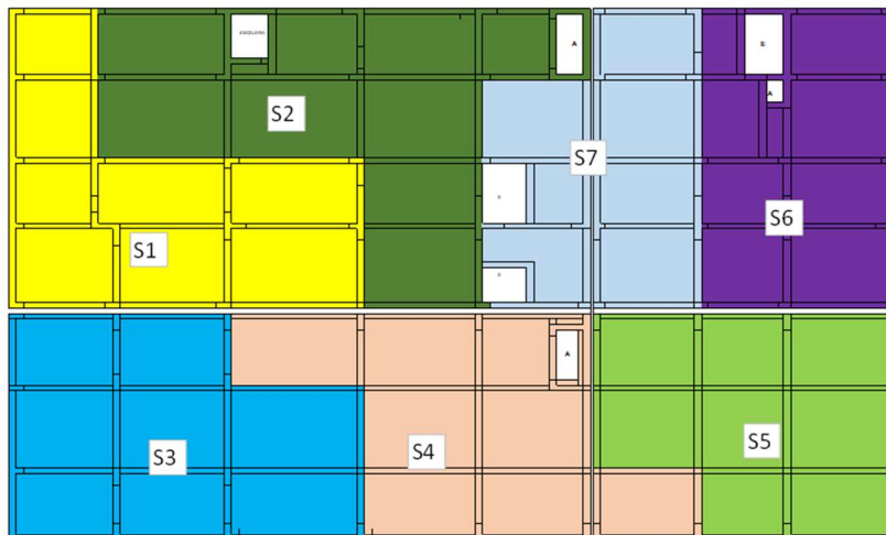
Figura 33. Ejemplo de sectorización de áreas de un proyecto
