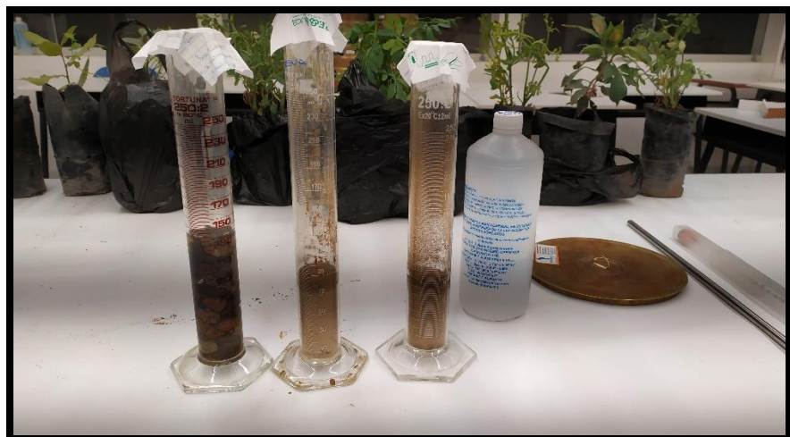
Fotografía N° 7 Ensayo de densidad aparente
