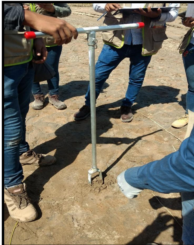
Fotografía N° 4 Extracción de muestra utilizando el Barreno Manual
