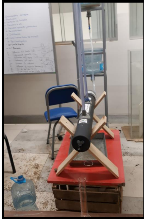
Fotografía N° 8 Ensayo de permeabilidad
