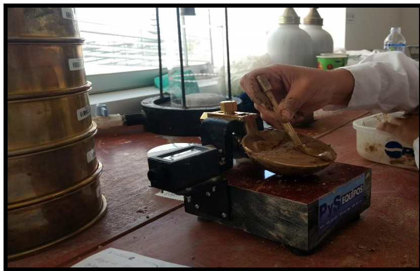
Fotografía N° 6 Determinación de plasticidad utilizando equipo Casagrande
