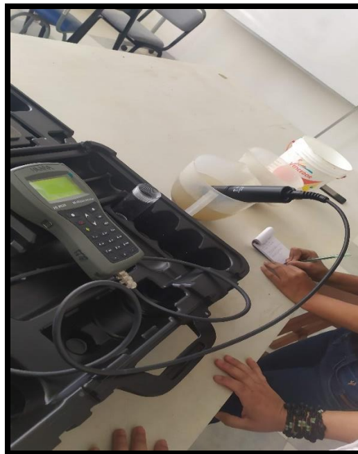
Fotografía N° 14 Determinación de pH y Conductividad Eléctrica, usando el Multiparámetro
