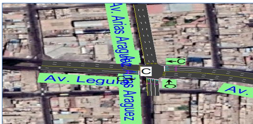
Figura N° 140: Nivel de Servicio de la Intersección N°01 Optimizando Ciclos con la ayuda del Programa y añadiendo carriles en los Accesos 1 y 3.
