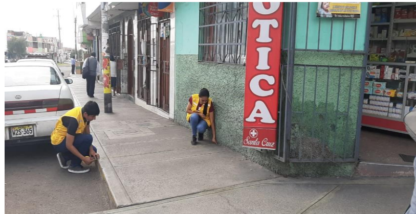
Imagen 5: Se aprecia las mediciones en campo del ancho de la vereda de la Av. Leguía – Av. Patricio Meléndez en la Intersección II.
