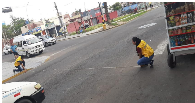
Imagen 11: Se aprecia las mediciones en campo del ancho de la vía en otro punto de la Av. Leguía – Calle General Vizquerra dada en la Intersección III.
