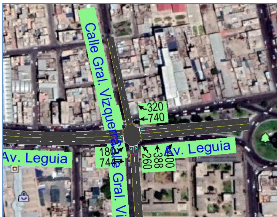
Figura N° 99: Volúmenes en la intersección 3 Av. Leguía – Calle General Vizquerra.
