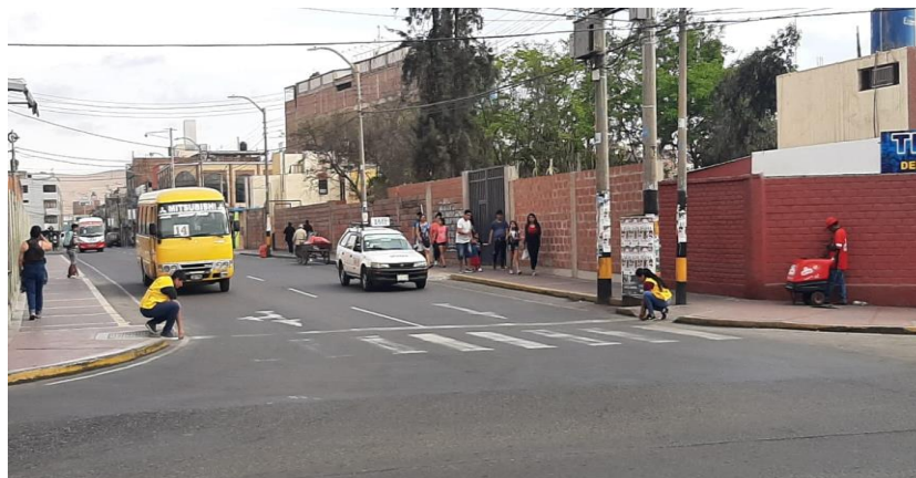
Imagen 10: Se aprecia las mediciones en campo del ancho de la vía de la Av. Leguía – Calle General Vizquerra dada en la Intersección III.
