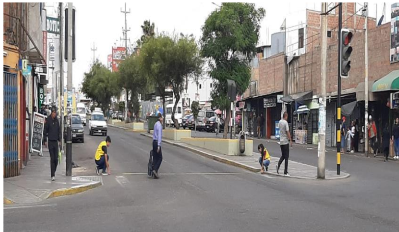
Imagen 6: Se aprecia las mediciones en campo del ancho de la vía de la Av. Leguía – Av. Patricio Meléndez en la Intersección II.
