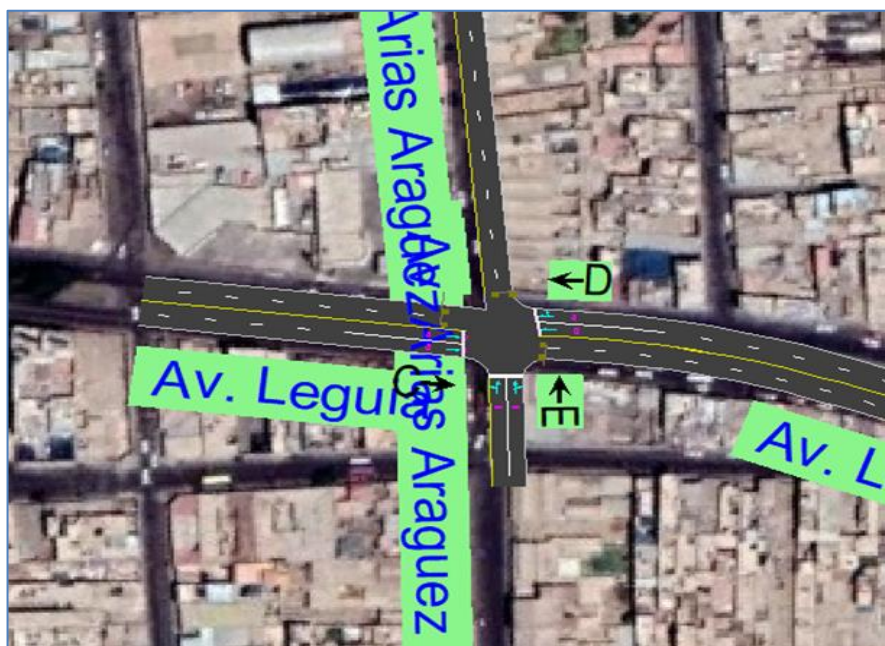
Figura N° 115: Nivel de Servicio de los Accesos Optimizado Ciclos de SemafORIZACIÓN en la Intersección 1.
