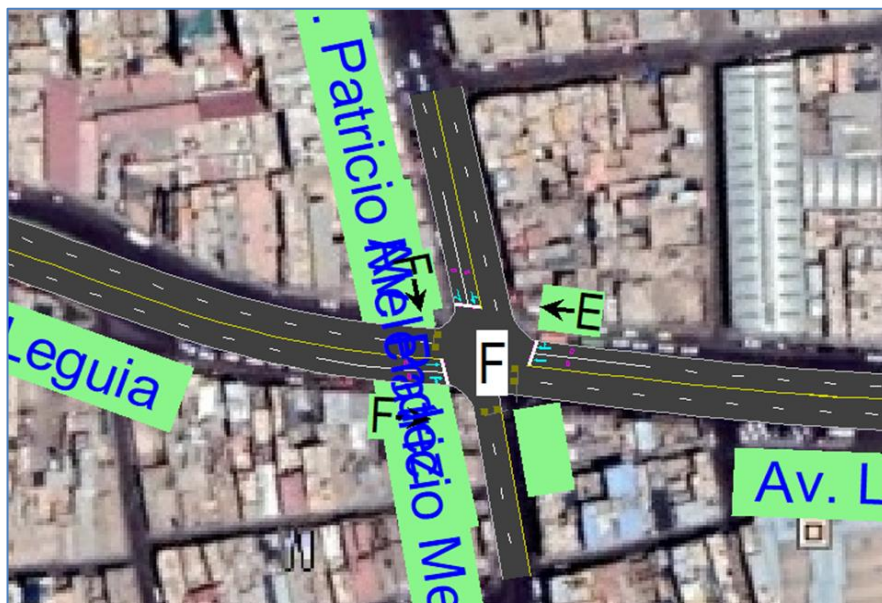
Figura N° 119: Nivel de Servicio de los Accesos Optimizado Ciclos de Semaforización en la Intersección 2.
