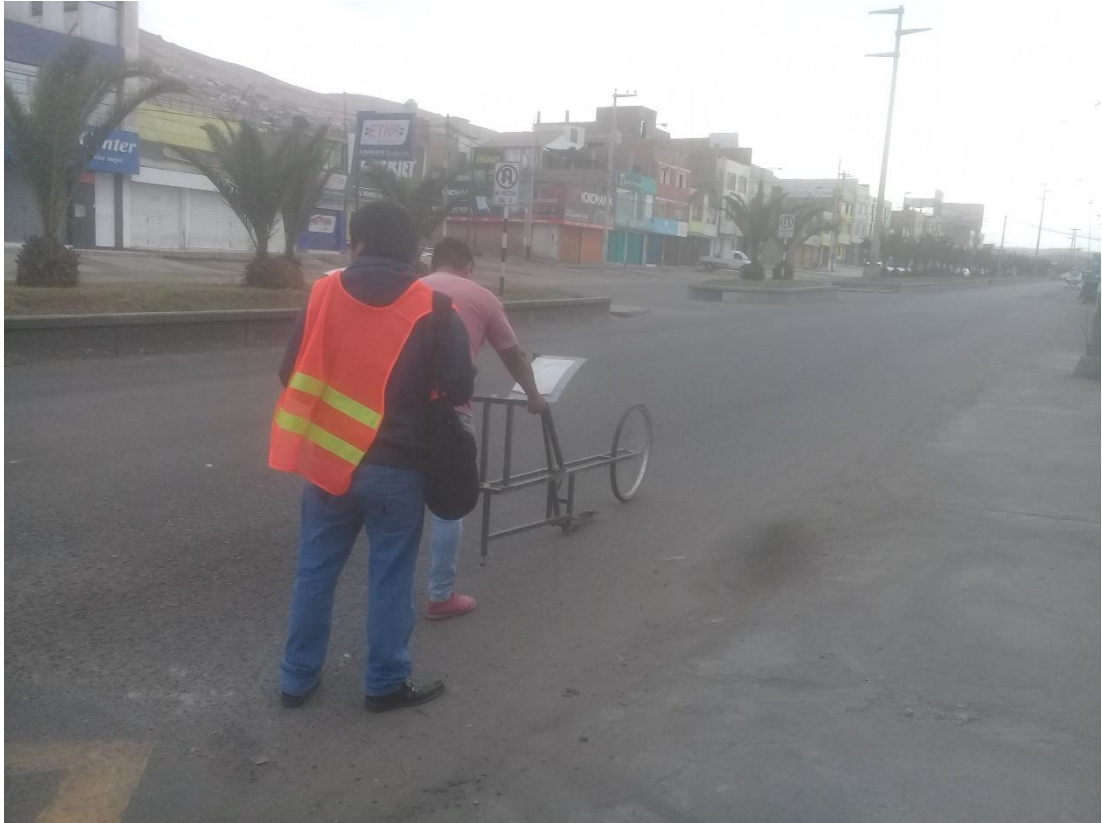
Fotografía 35. Ensayo con el rugosímetro de Merlín.
