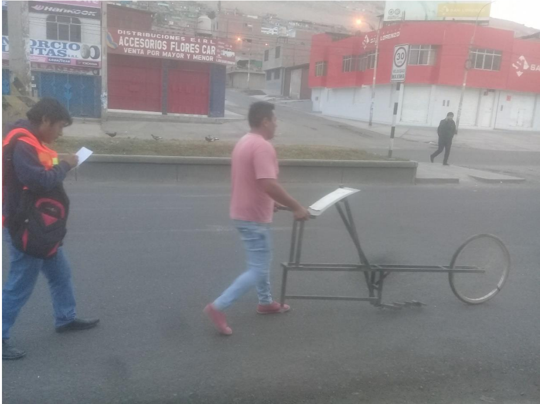
Fotografía 31. Ensayo con el rugosímetro de Merlín.
