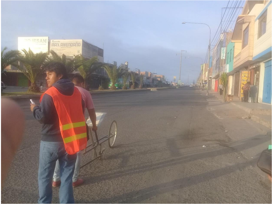
Fotografía 39. Ensayo con el rugosímetro de Merlín.
