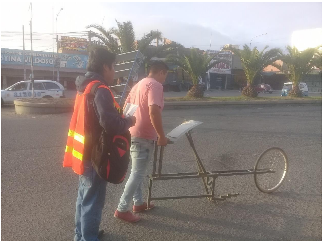
Fotografía 38. Ensayo con el rugosímetro de Merlín.
