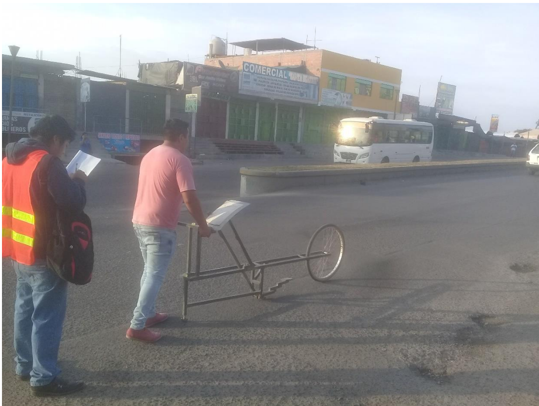
Fotografía 41. Ensayo con el rugosímetro de Merlín.
