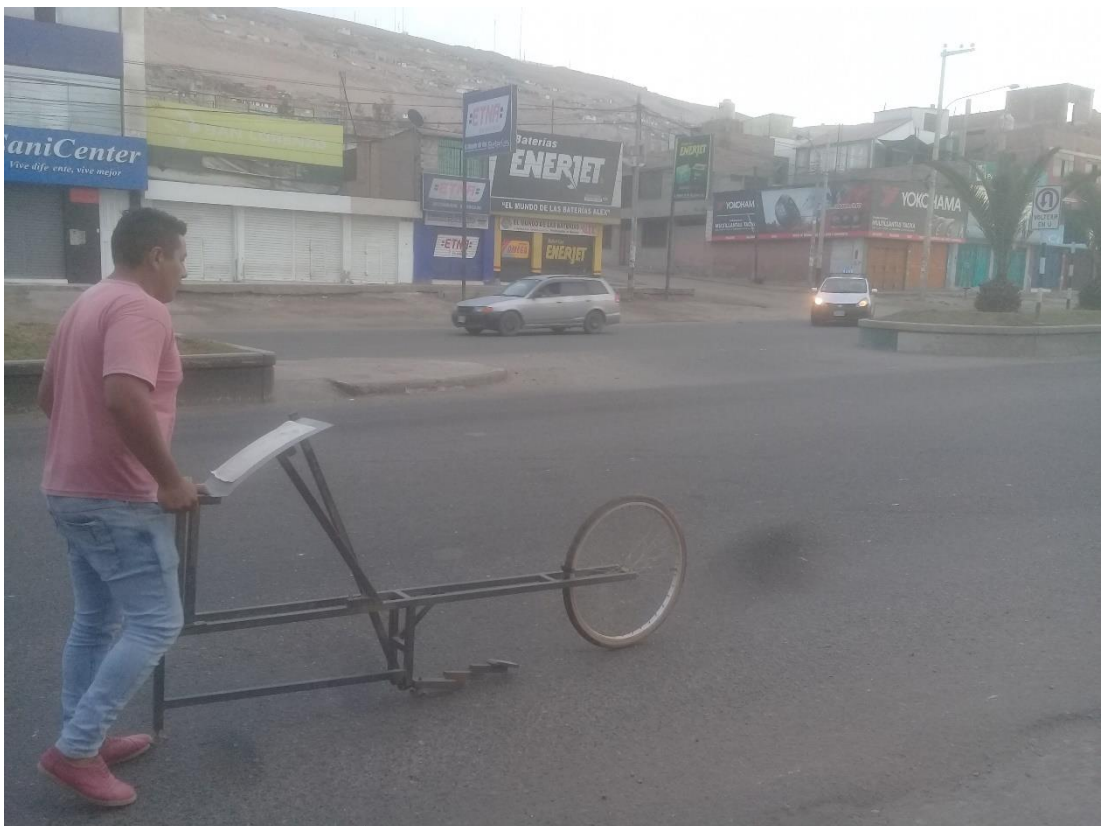
Fotografía 36. Ensayo con el rugosímetro de Merlín.
