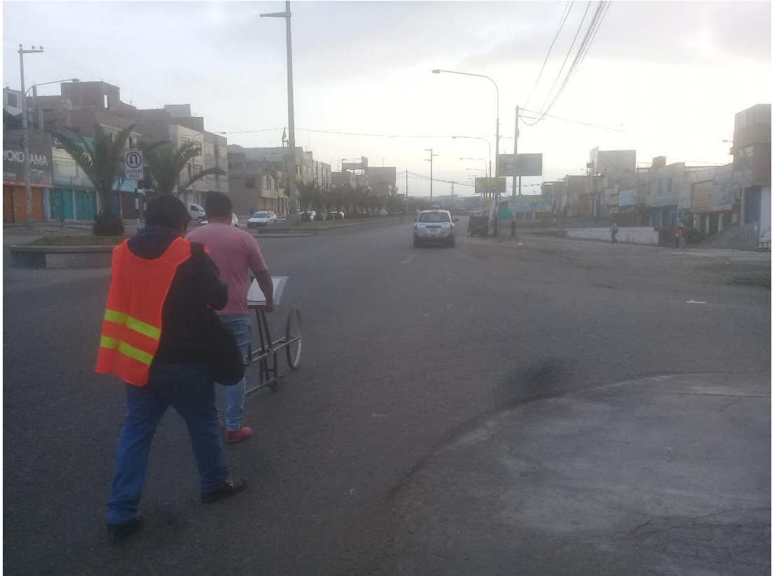
Fotografía 37. Ensayo con el rugosímetro de Merlín.
