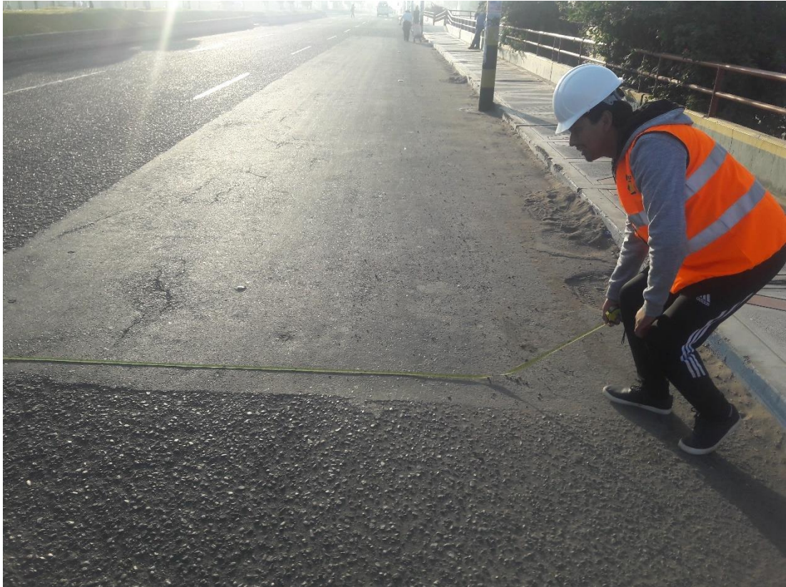
Fotografía 15. Medición del área para el tipo de falla de Parcheo para el PCI.
