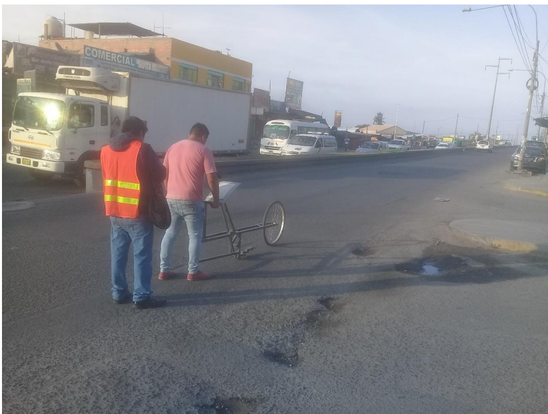
Fotografía 42. Ensayo con el rugosímetro de Merlín.
