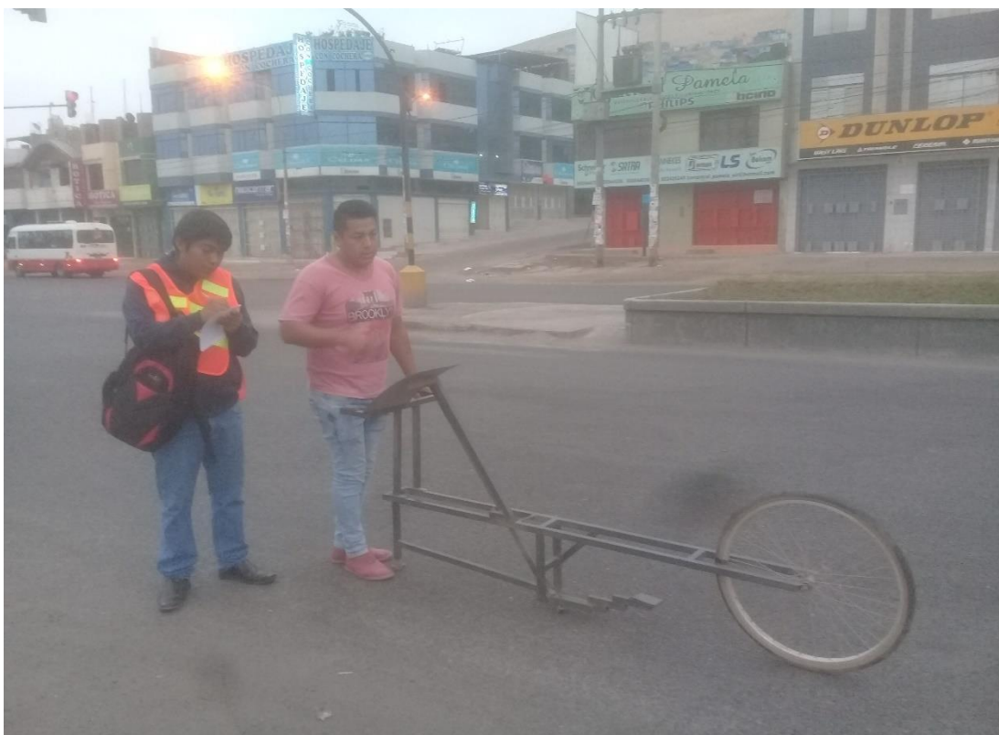
Fotografía 26. Medición de la rugosidad del pavimento con el rugosímetro de Merlín en la avenida Jorge Basadre Grohmann.
