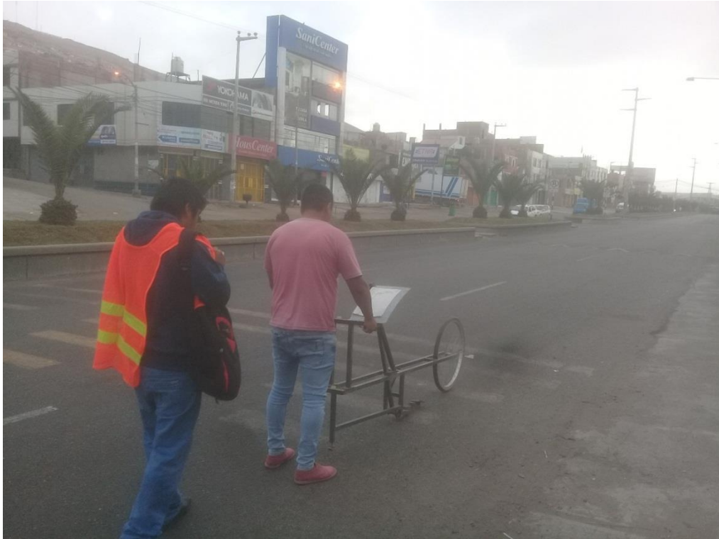
Fotografía 33. Ensayo con el rugosímetro de Merlín.
