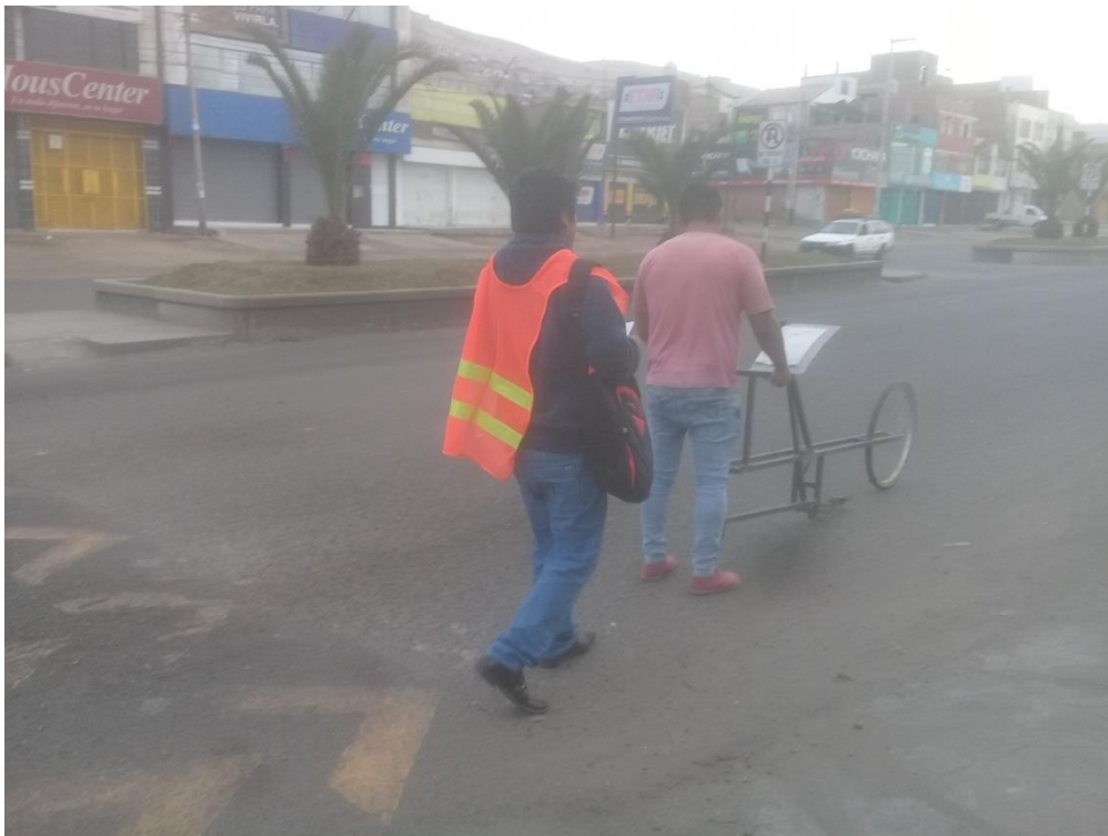
Fotografía 34. Ensayo con el rugosímetro de Merlín.
