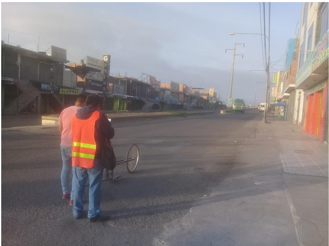
Fotografía 40. Ensayo con el rugosímetro de Merlín.
