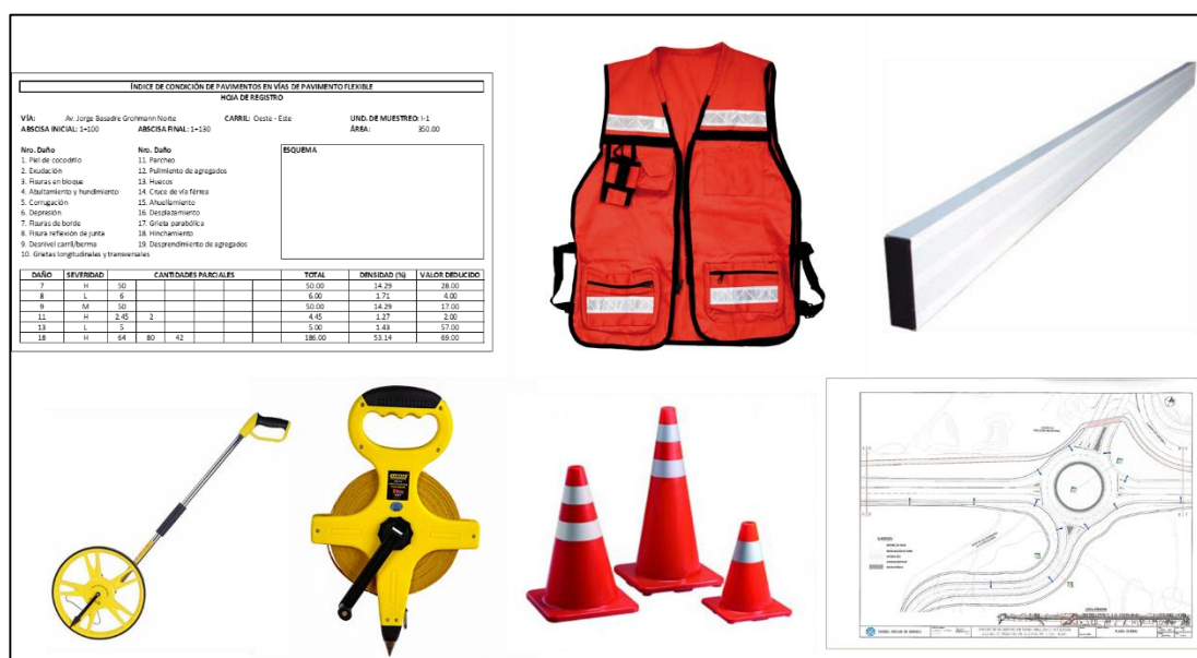
Figura 6. Herramientas para la evaluación por el método del PCI.
