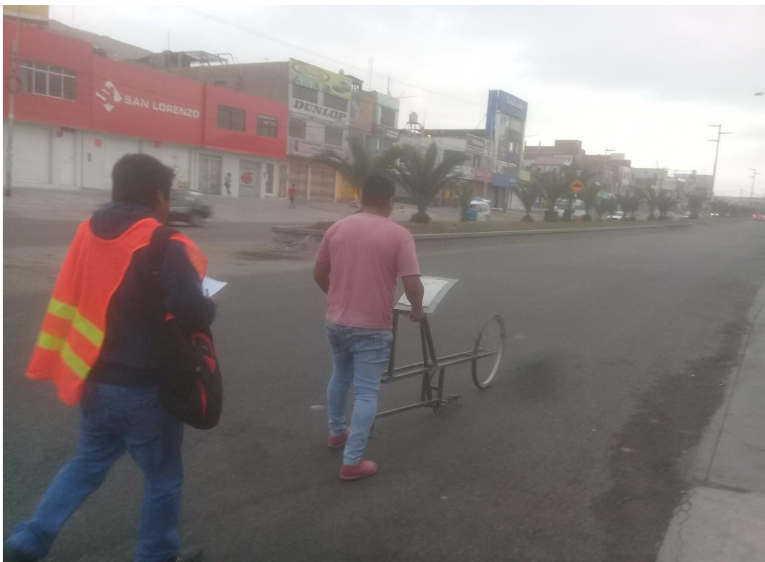
Fotografía 32. Ensayo con el rugosímetro de Merlín.
