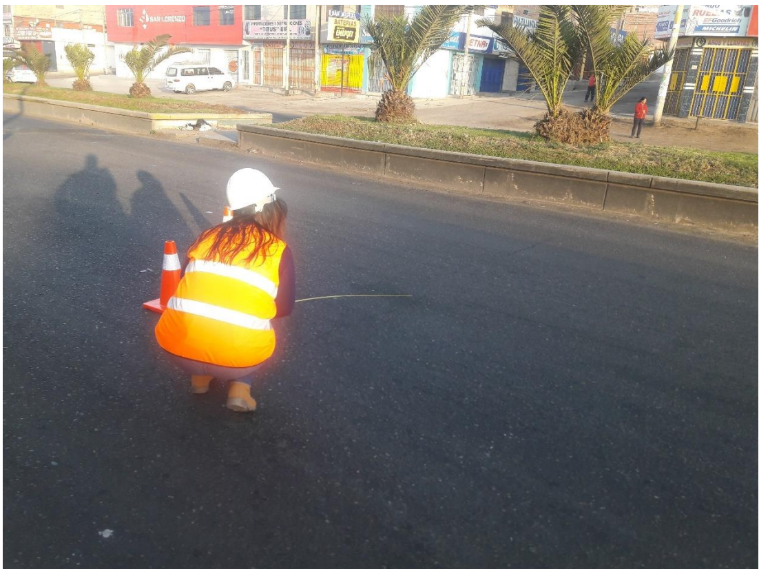
Fotografía 4. Obtención del área para el tipo de falla de Hundimiento para el PCI.
