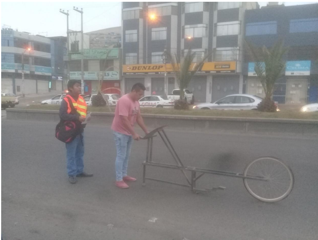
Fotografía 27. El asistente del técnico operador del rugosímetro anota las lecturas obtenidas.
