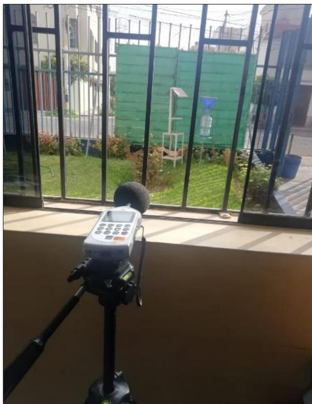
*Figura 7.* Sonómetro y Trípode, Equipo para Mediciones de Nivel de Ruido
