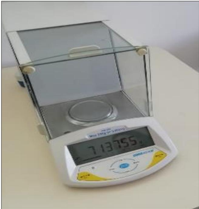
*Figura 6. Balanza Analítica para Pesar Placas Receptoras*
