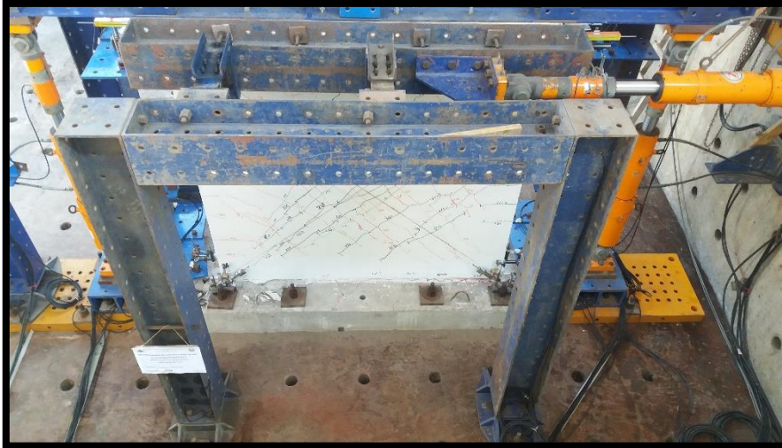
Figura 55. Finalización del ensayo cíclico de carga lateral para MBATR-3
