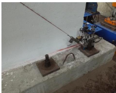
Foto 1. Formación de las primeras grietas en la base del muro para una distorsión 1/2150.
