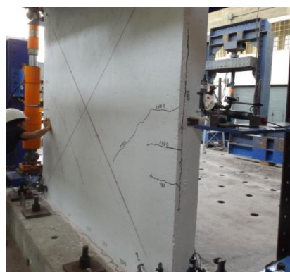
Foto 4. Grietas a flexión y separación del recubrimiento para una distorsión 1/1100.
