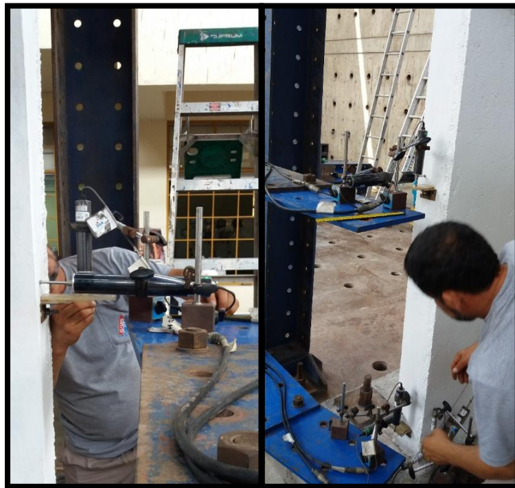
Figura 3.37. Colocación de los LVDTs (Transformador diferencial de variación lineal) en los extremos del espécimen.
