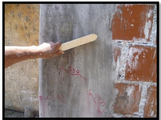
Figura 31. Muro posterior a ensayo cíclico de carga lateral (izquierda)
