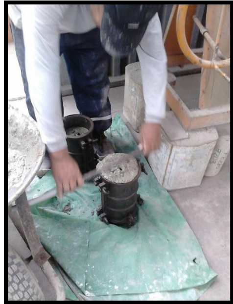
Figura 23. Testigos de concreto de las columnas para verificación de resistencia
