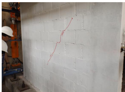
Foto 2. Grietas diagonal en el centro del muro (cara sur- jalando) para una distorsión 1/1500.
