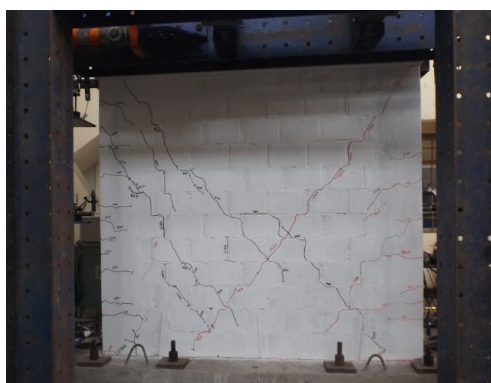
Foto 11. Aparición de más grietas diagonales en el muro para la distorsión 1/200.
