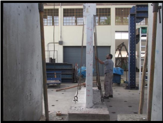
Figura 31. Muro posterior a ensayo cíclico de carga lateral (izquierda)
