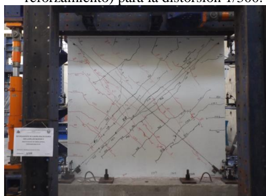
Foto 12. Estado de agrietamiento final del muro para una distorsión 1/150.
