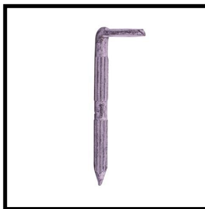
Figura 3.5. Clavo de acero Estriado tipo L 4x40mm para amarrar y fijar la malla al muro
