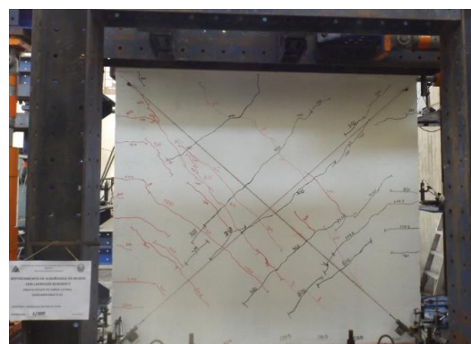
Foto 10. Formación de más grietas diagonales cercanas a las columnas (cara con reforzamiento) para la distorsión 1/300.
