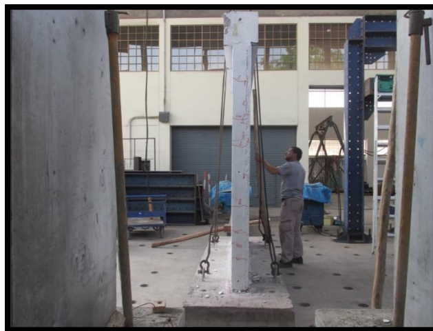
Figura 3.15. Especimen MBAT-3 posterior a ensayo cíclico de carga lateral.
