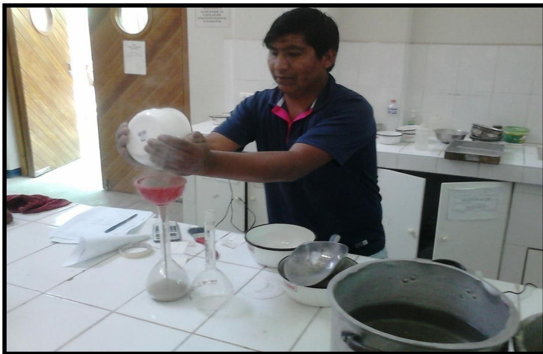
Fotografía 16. Inicio del ensayo de peso específico de la arena.
