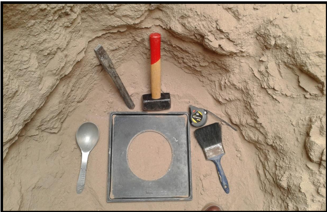
Fotografía 13. Fijando la base porta cono.
