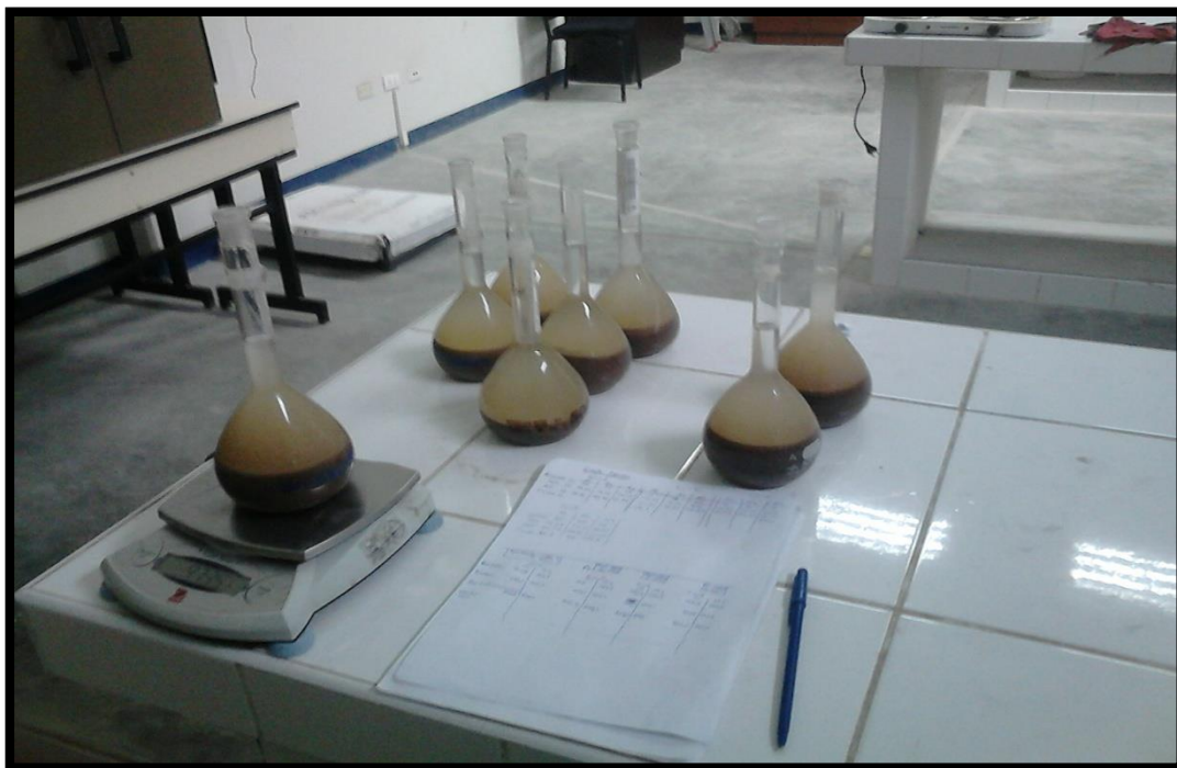
Fotografía 18. Obtención del peso final de la muestra, sin aire atrapado.
