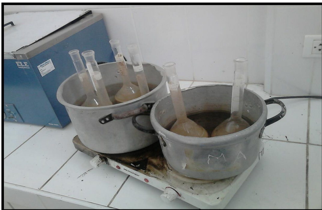
Fotografía 17. Eliminación de las burbujas de aire de la muestra.
