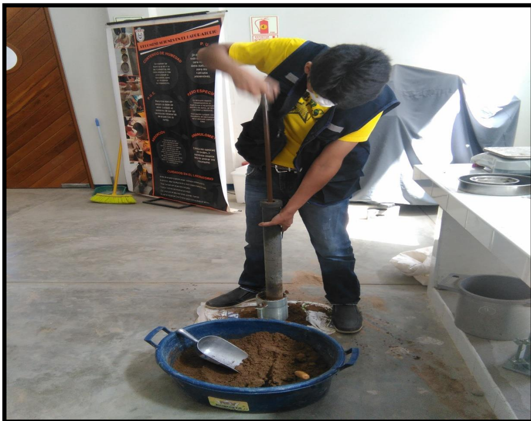
Fotografía 24. Se procede a dar 25 golpes por cada capa.
