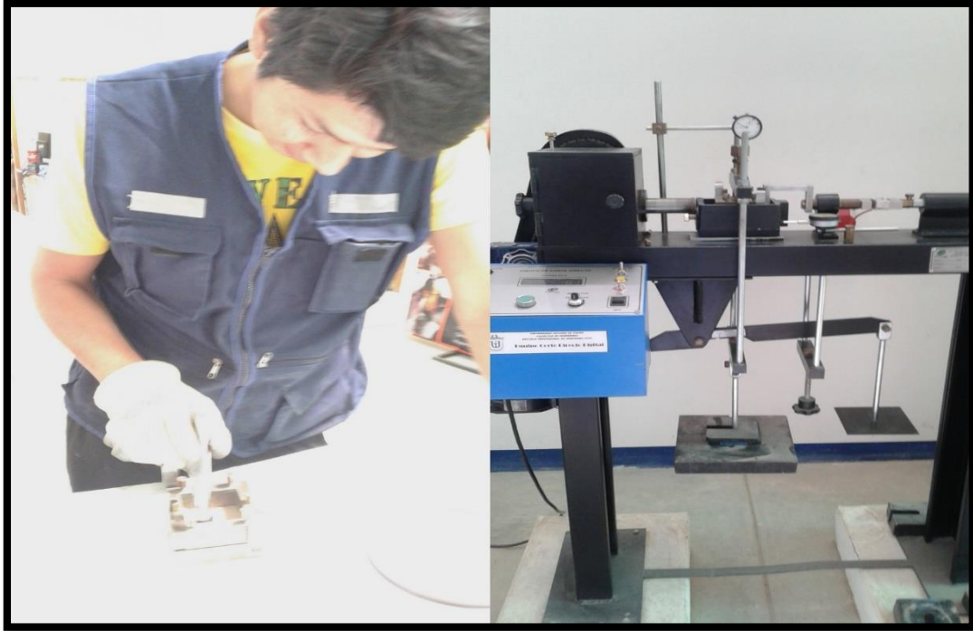
Fotografía 26. Preparación de la muestra y llevado el equipo de corte directo.
