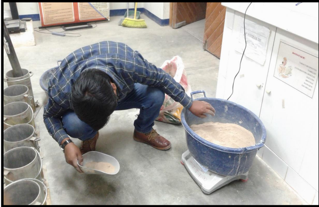
Fotografía 22. Pesado de la muestra para determinar densidad máxima.
