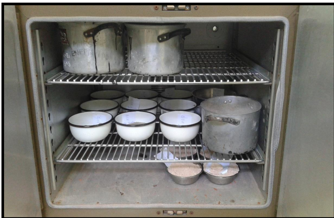
Fotografía 21. Secado de las muestras para determinar su humedad.
