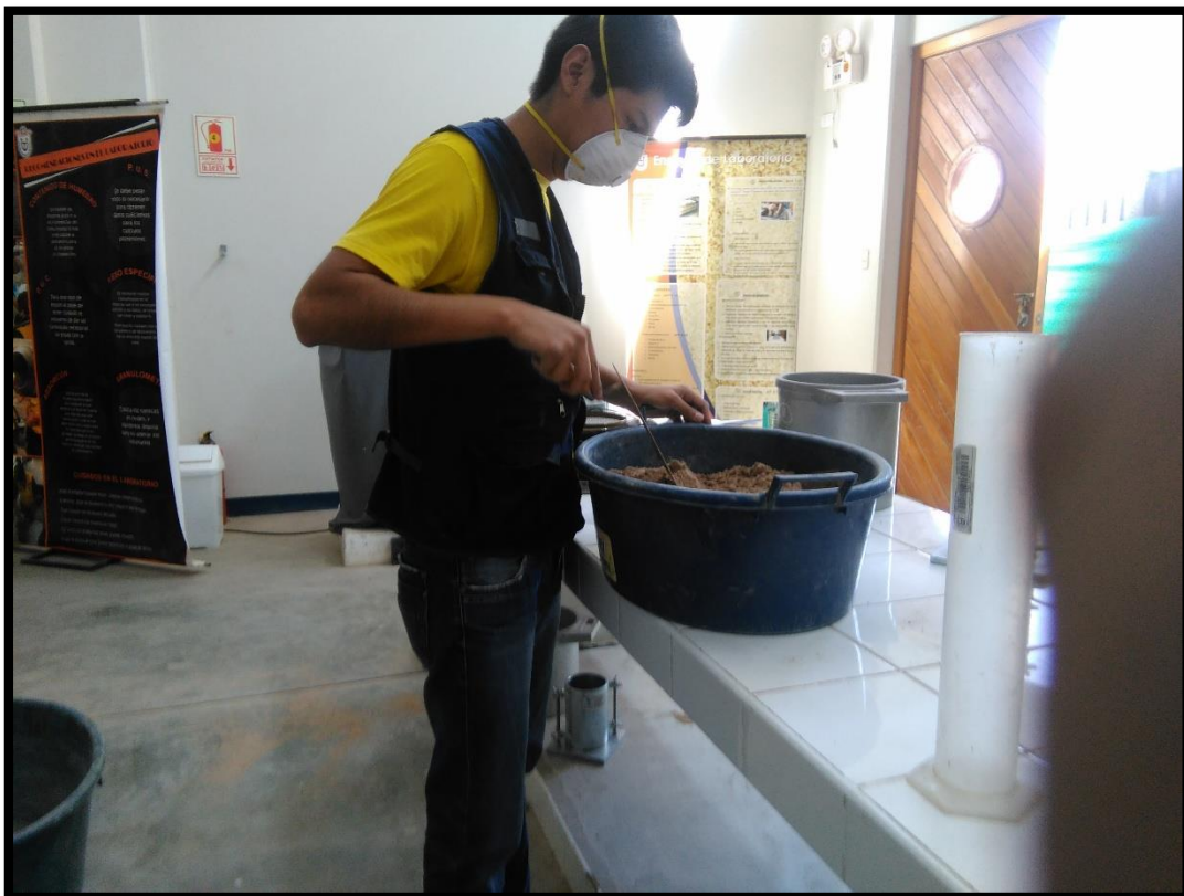
Fotografía 23. Preparación de la muestra para el ensayo de Proctor modificado.
