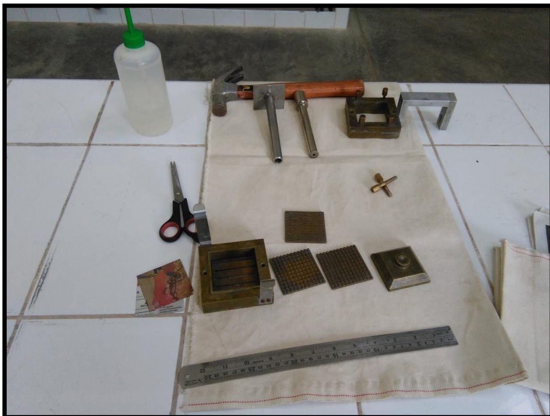
Fotografía 25. Preparación de la caja de sección cuadrada.
