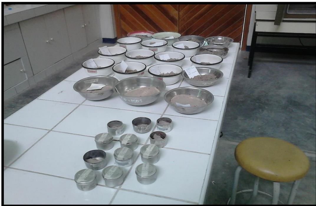
Fotografía 20. Preparación de la muestra húmeda.
