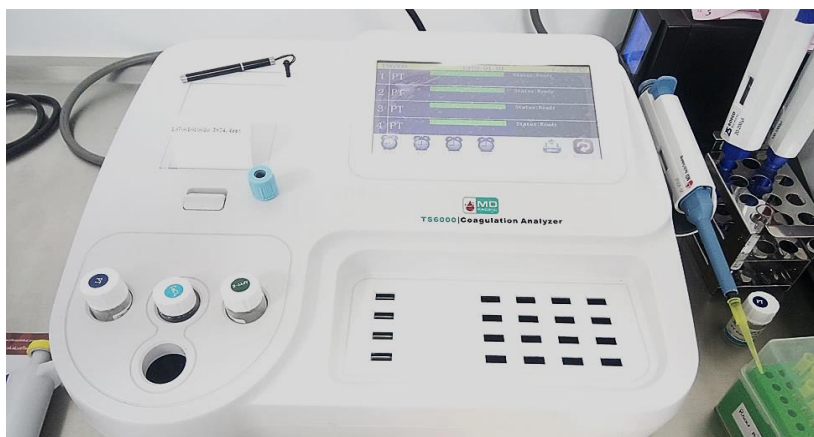
Figura 5. Equipo de coagulometría semiautomatizado MD PACIFIC 6 000
