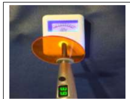
Medición en Radiómetro de la intensidad de luz de la lámpara. Registra 950w/cm 2
