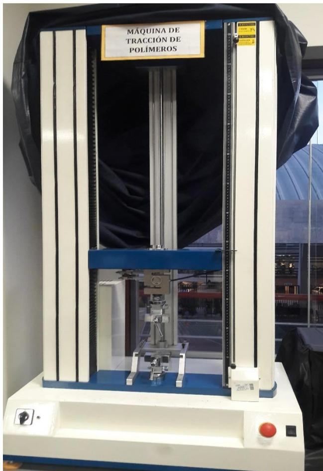
Máquina Universal de Ensayos para Tracción de 3.000 Kg (Instron, modelo 4467 Londres, Inglaterra).
