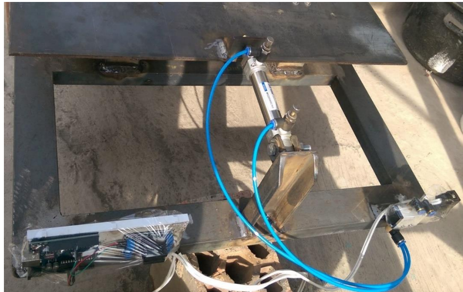
Fotografía 6 Válvula solenoide, Relay, tarjeta arduino y cilindro neumático ya montada en la mesa vibradora a escala
