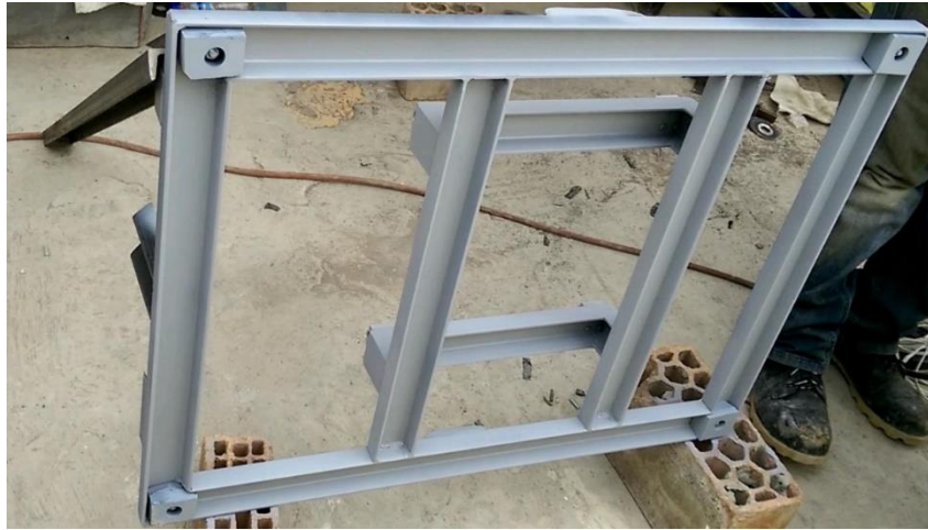
Figura 4.8 Vista de planta inferior de la mesa de cimentación ya terminada
