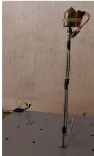
Figura 4.23 Colocación de los acelerómetros en la propuesta final a ensayar
