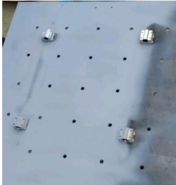
Fotografía 1 Vista lateral inferior de la plataforma con los rodamientos lineales ya empotrados
