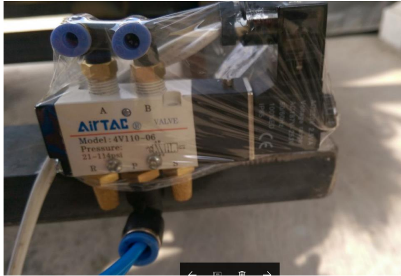
Fotografía 5 Válvula solenoide serie 4V100 ya montada en la mesa vibradora a escala
