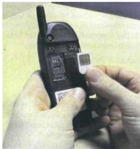
Figura 8: Insertando la tarjeta SIM en un teléfono móvil.
