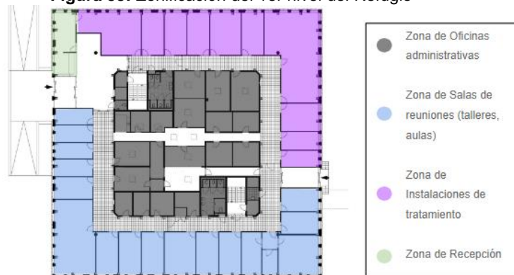
Figura 53: Zonificación del 1er nivel del Refugio
