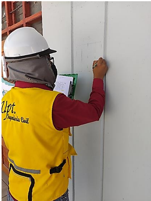
Figura 26 Demarcación de la zona para el ensayo de esclerometría
