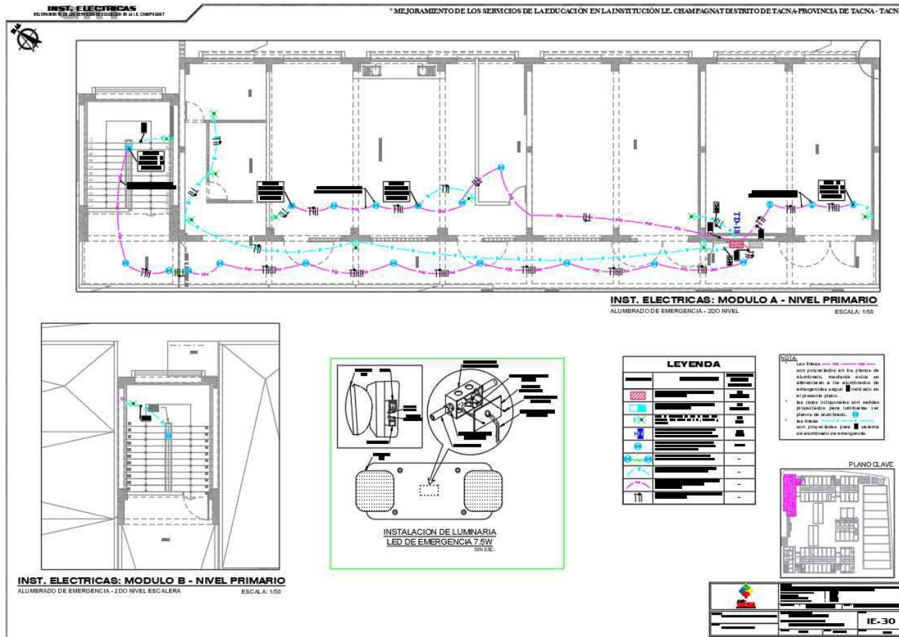
Alumbrado de Emergencia del 2do Nivel
