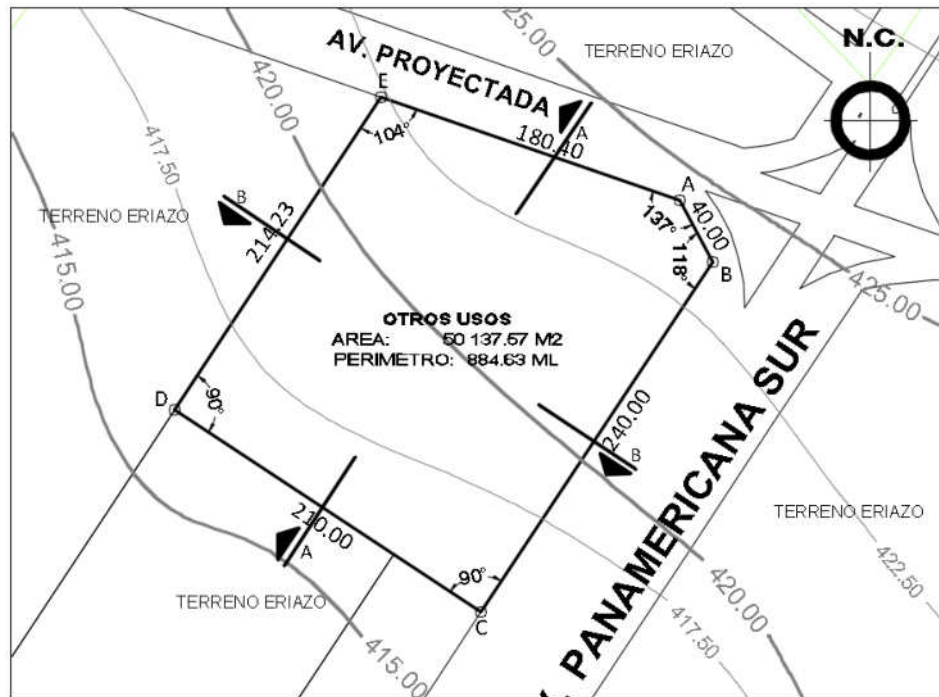
Figura 82. Plano topográfico del terreno
