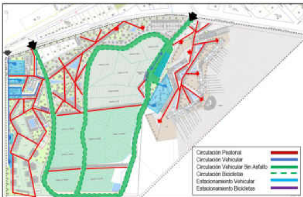
Figura 197: Accesibilidad Vehicular y Peatonal
