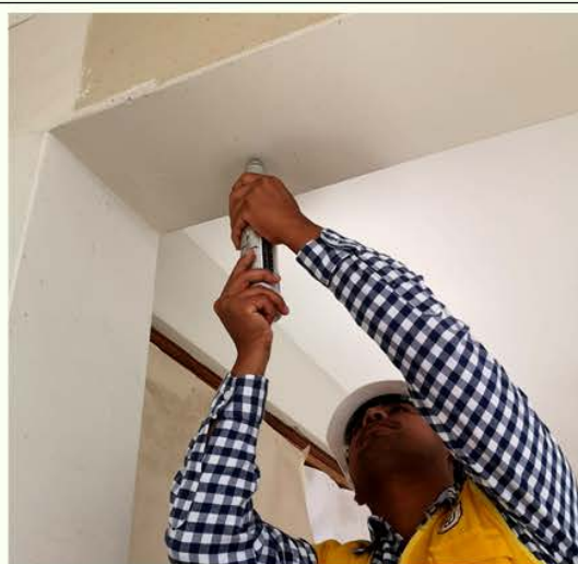
Imagen 04. Ensayo con esclerómetro - Viga 2
