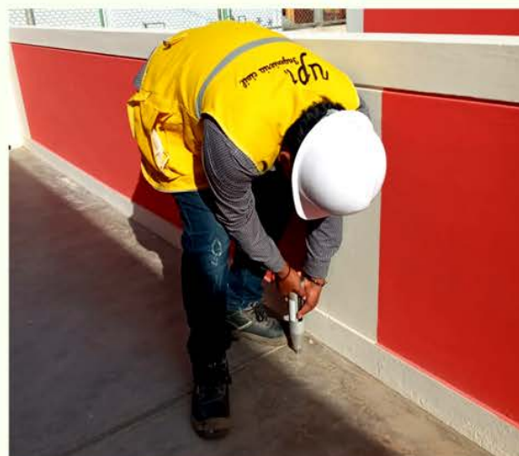
Imagen 04. Ensayo con esclerómetro - Viga 2
