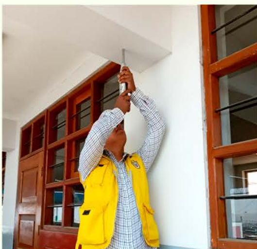
Imagen 03. Ensayo con esclerómetro - Viga 1
