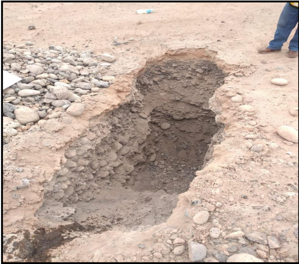
Fotografía 3: Excavación de la Calicata C – 1 en el sector 12 San Antonio.
