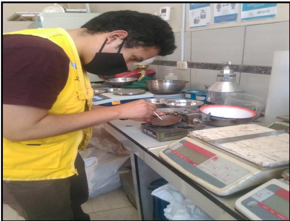
Fotografía 28: Realizando los ensayos de límites de Atterberg con la Copa de Casagrande.
