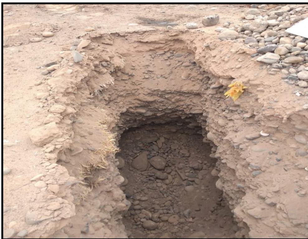
Fotografía 5: Excavación de la Calicata C – 2 en el sector 12 San Antonio.
