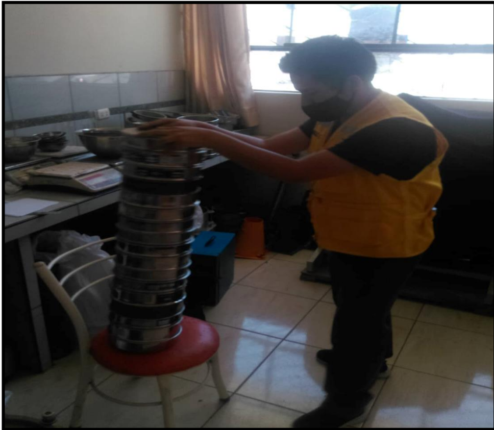
Fotografía 23: Realizando ensayo de granulometría con todos los tamices para su separación.
