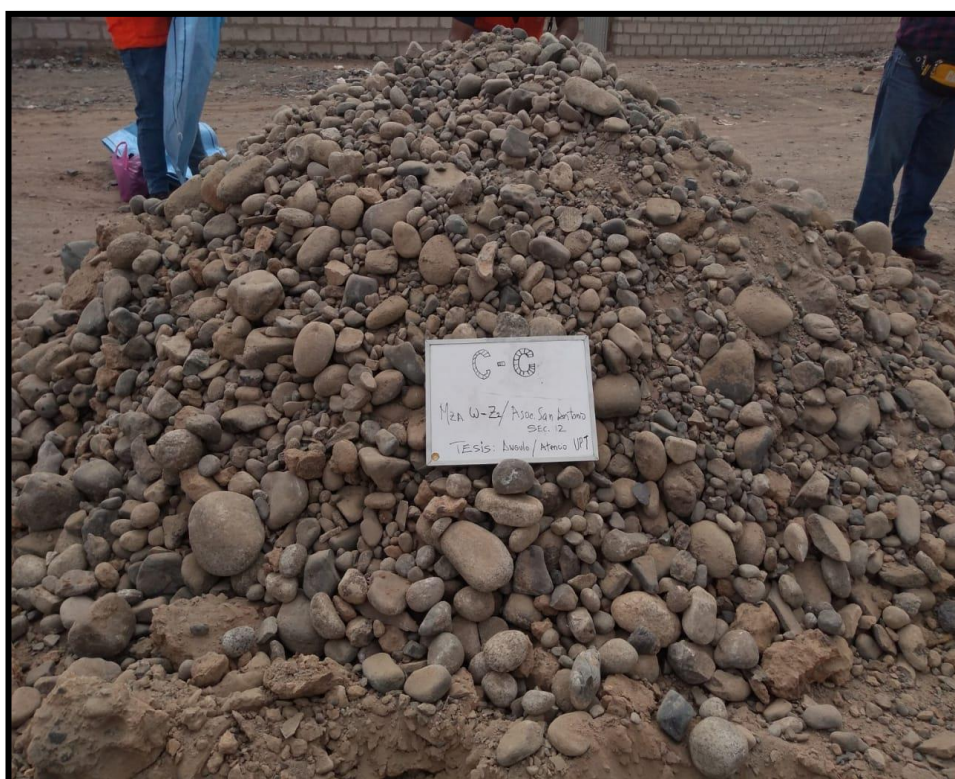
Fotografía 21: Realización de la calicata C – C en el sector 12 San Antonio.
