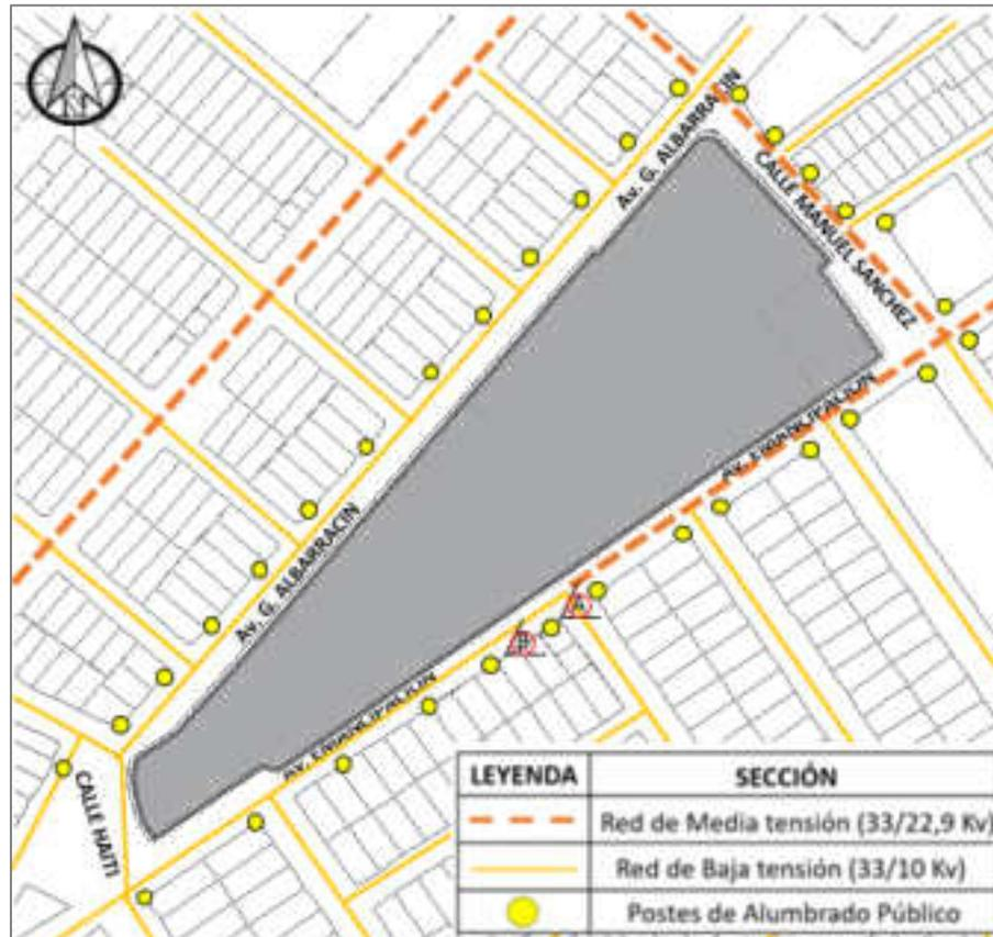
Figura N°100: Red de energía eléctrica del terreno
