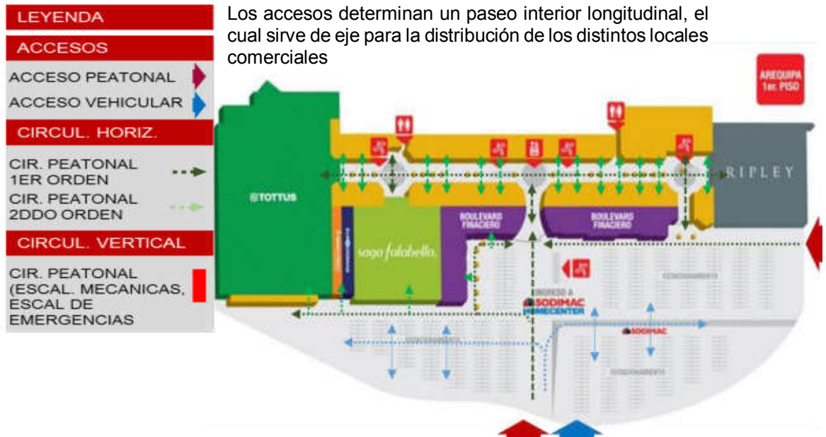
Ilustración 19: Analisis espacial y funcional primer nivel del Centro Comercial Mall Aventura Plaza
