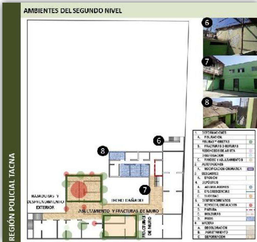
Figura 51 Daños en la infraestructura de la Región Policial Tacna - Segunda Planta
