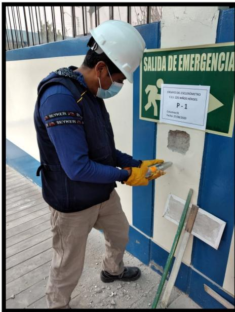
Nota: En la figura 19 se muestra la lectura P1 que se hizo con el ensayo del esclerómetro en la columna. Fuente: Elaboración propia
