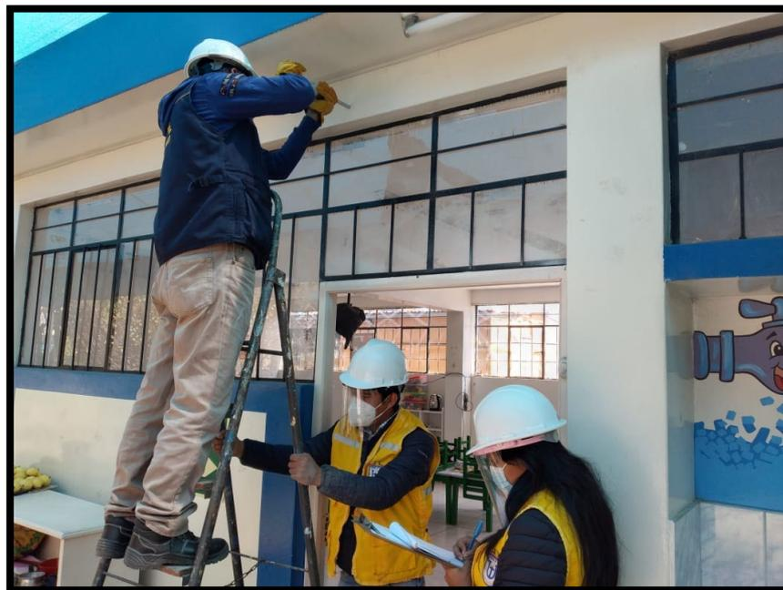
***Ensayo de esclerómetro en viga de amarre***
