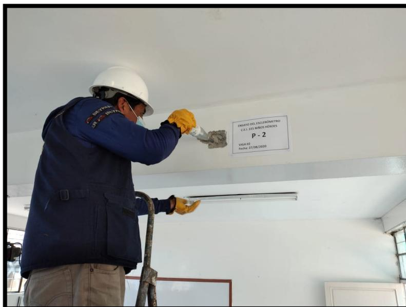
Nota: En la figura 20 se muestra la lectura P2 que se hizo con el ensayo del esclerómetro en la viga. Fuente: Elaboración propia.
