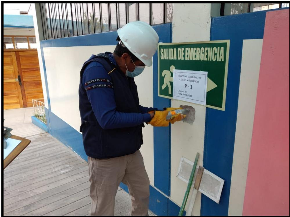
***Ensayo de esclerómetro en PUNTO - 1 de columna***
