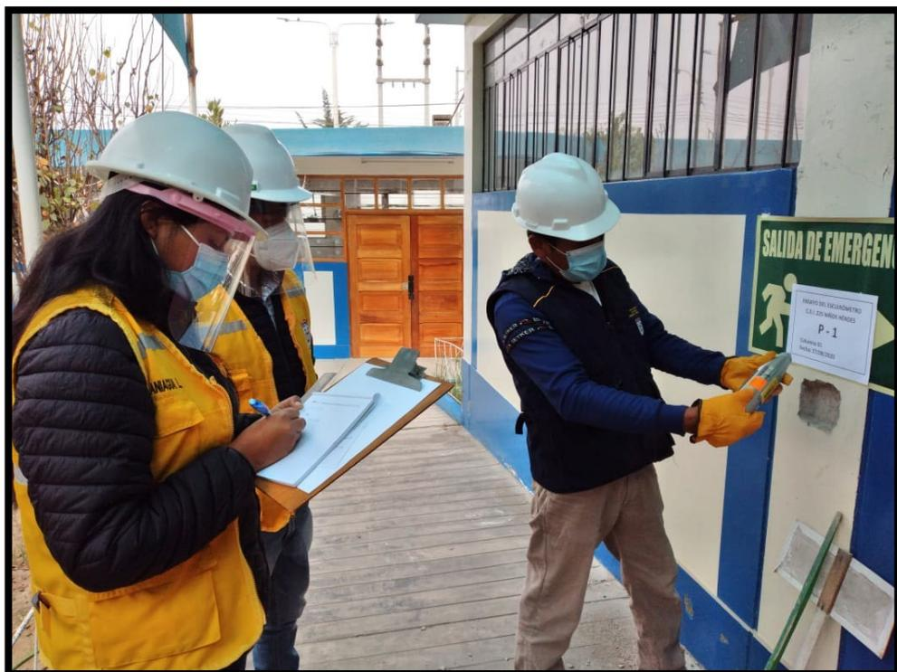
***Toma de apuntes de medidas del ensayo de esclerómetro***
