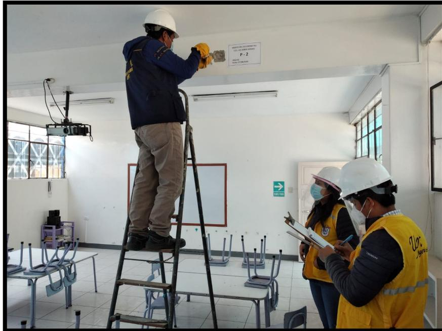
***Ensayo de esclerómetro en PUNTO - 2 de viga peraltada***
