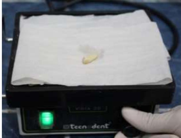
Figura 27. Colocación de cada pieza dentaria en un vibrador.
