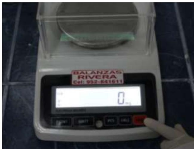
Figura 21. Estabilizada balanza analítica.
