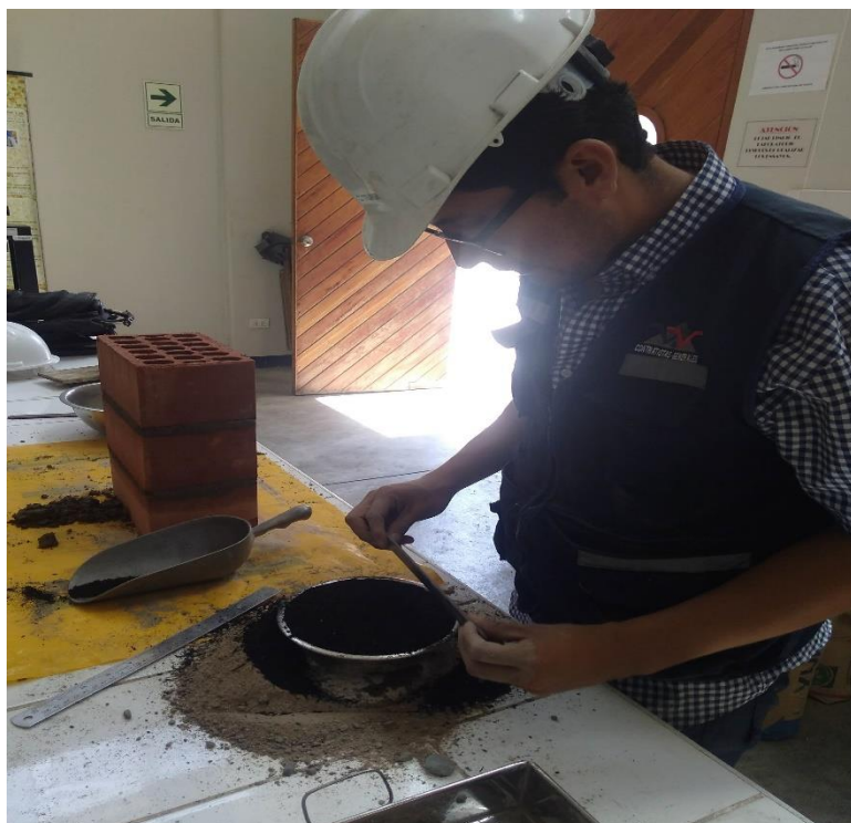
FOTO N°06: ASENTADO CON USO DE MATERIAL ALTERNATIVO POLVO DE CAUCHO, AFECTANDO LA PROPORCION DE LA ARENA GRUESA 1:4.
