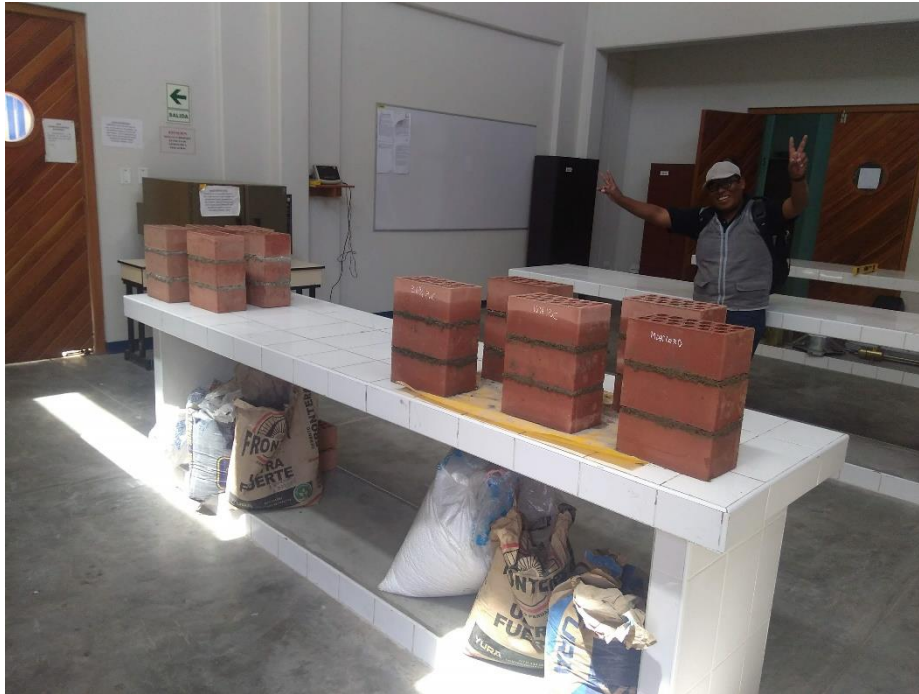
FOTO N°07: PARTE DE LAS PILAS YA CONSTRUIDAS PARA SOMETERLAS A ENSAYOS Y CALCULAR LA COMPRESION AXIAL ( f'm ).
