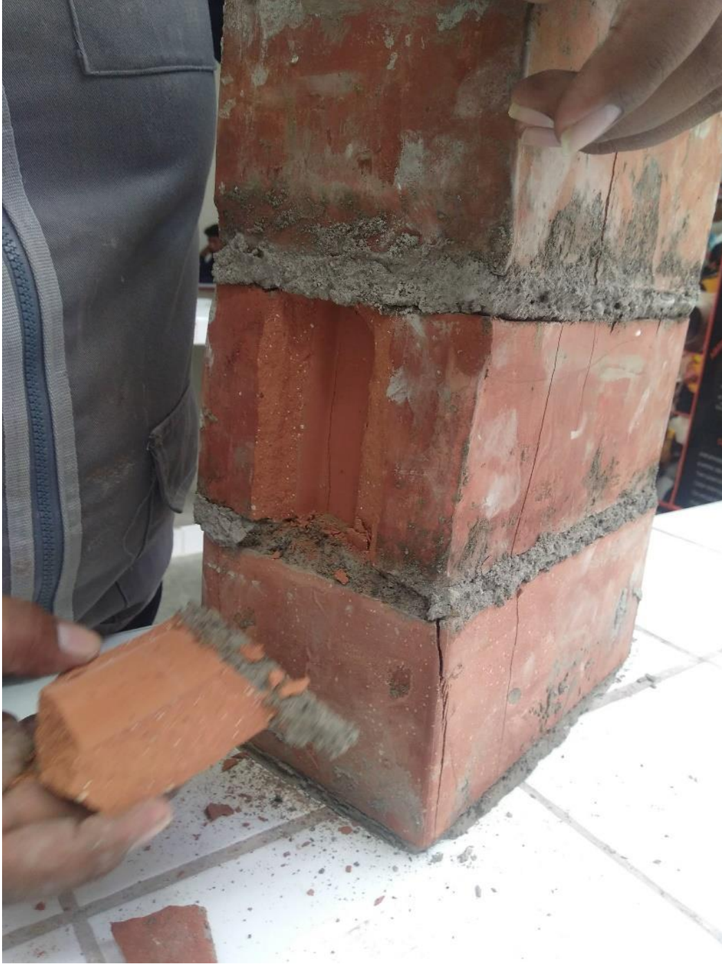
FOTO N°10: FALLA POR TRITURACION DE LA PILA CON EL 30% DE POLVO DE CAUCHO.
