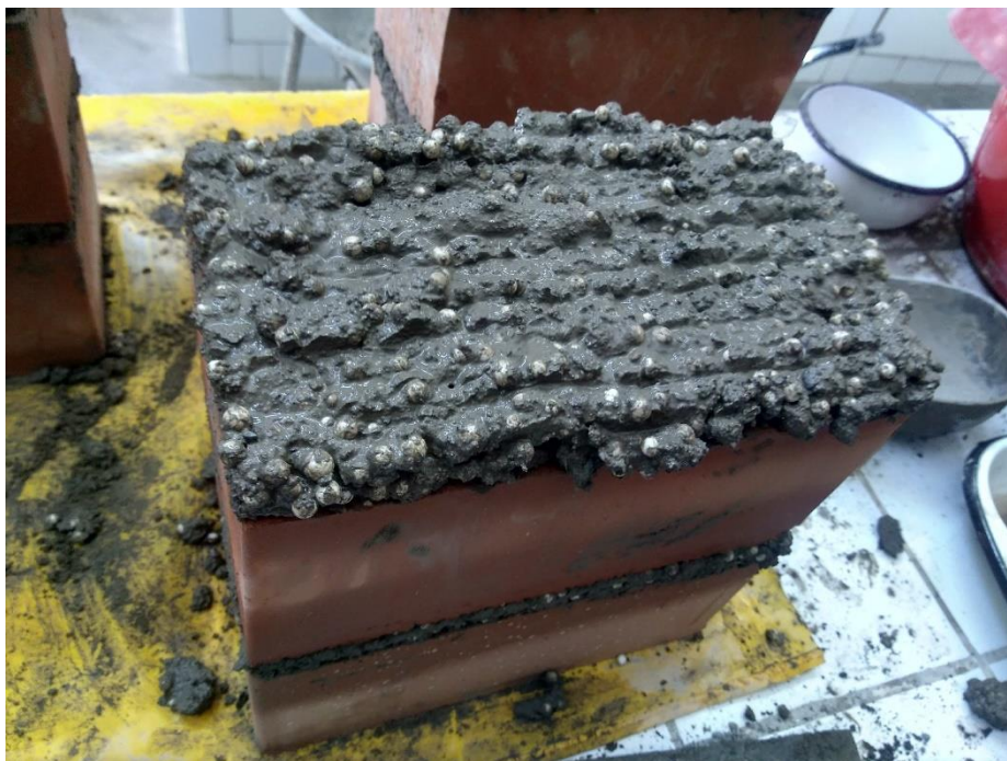
FOTO N°04: ASENTADO DE PILAS CON MATERIAL ALTERNATIVO, PERLAS DE POLIESTIRENO EXPANDIDO.
