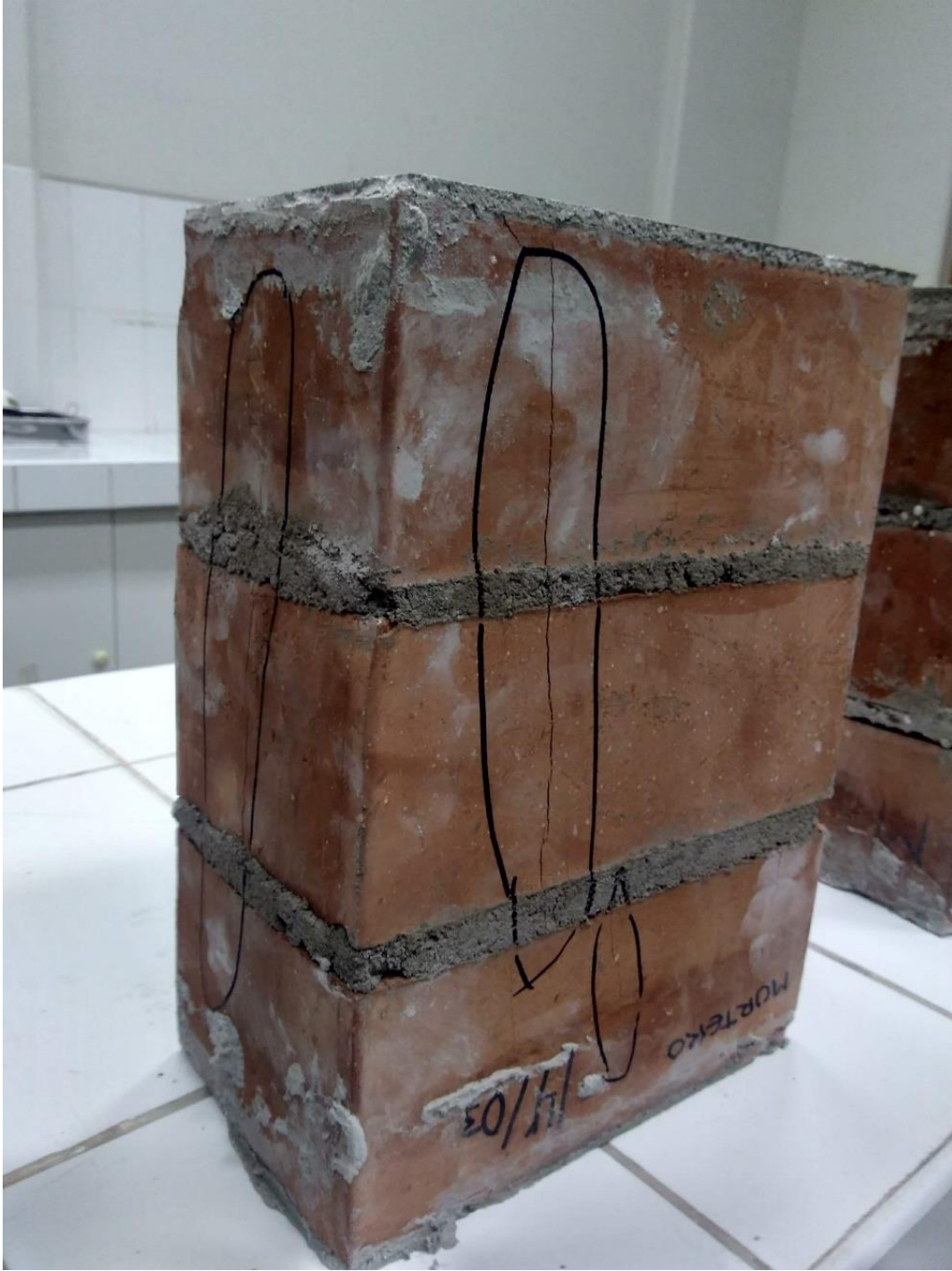
FOTO N°09: FALLA POR AGRIETAMIENTO VERTICAL, CORTANDO LA UNIDAD Y EL MORTERO, EN ESTE CASO EL MORTERO TRADICIONAL.
