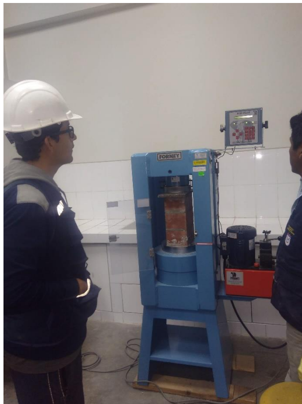
FOTO N°08: CUMPLIENDO LOS 28 DÍAS PARA HACER EL ENSAYO DE COMPRESION.
