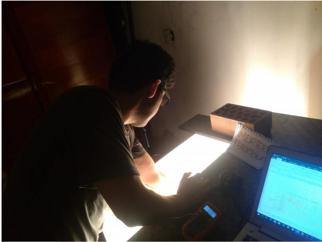
FOTO N°20: TOMA DE TEMPERATURA PARA EL MORTERO TRADICIONAL, DURANTE LA ETAPA DE CALENTAMIENTO TOMAR LA TEMPERATURA CADA 30MIN.
