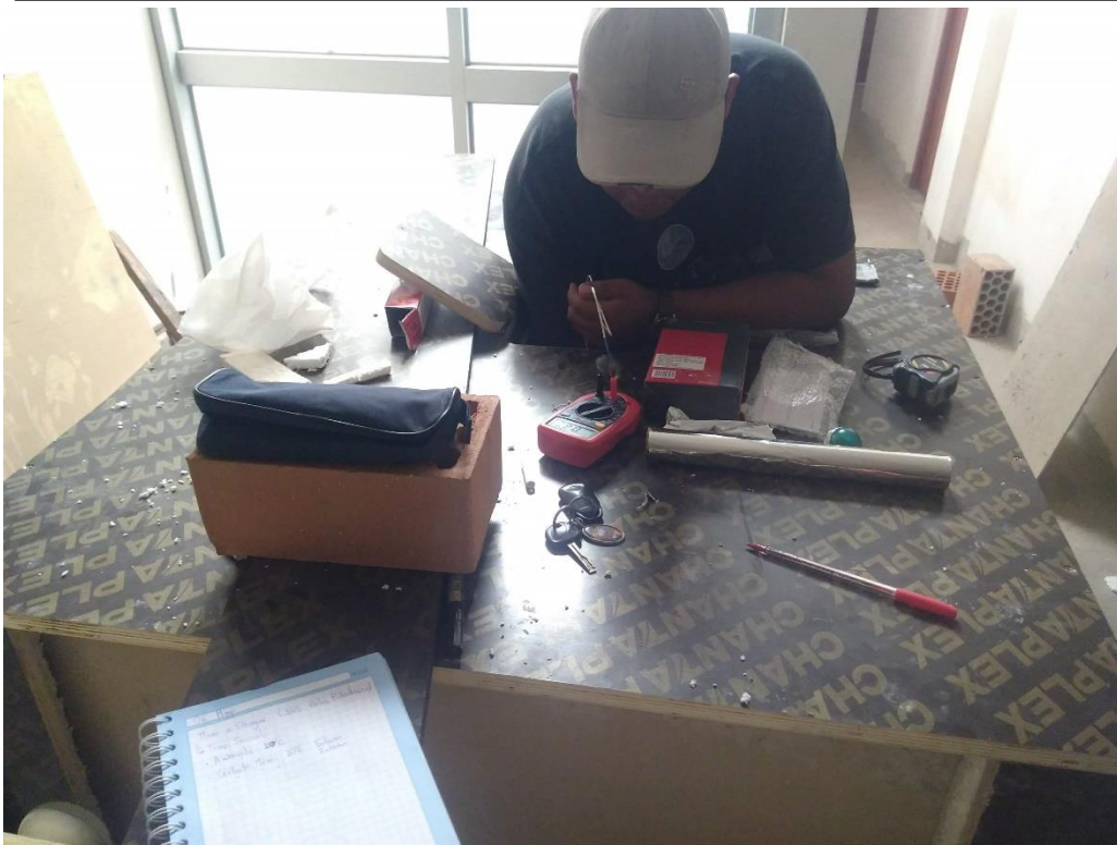
FOTO N°21: TOMA DE TEMPERATURA DURANTE LA ETAPA DE ENFRIAMIENTO CADA 30MIN, POR 4HRS, PARA FINALMENTE ARMAS LAS CURVAS DE CALENTAMIENTO Y ENFRIAMIENTO.
