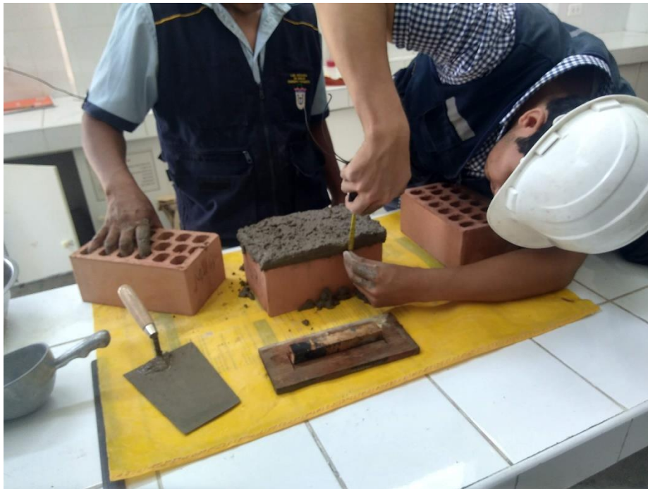
FOTO N°03: ASENTADO DE LAS PILAS DE ALBAÑILERIA A 3 HILADAS, RESPETANDO EL MORTERO DE 1.5CM.
