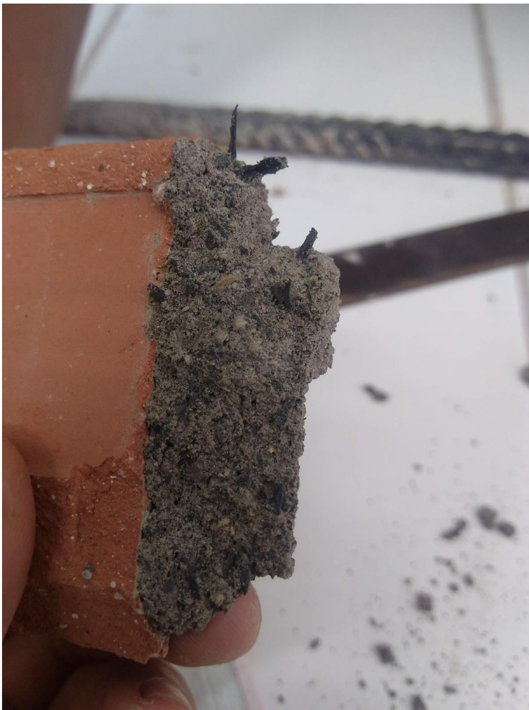
FOTO N°11: UN DETALLE MUY IMPORTANTE AL 30% DE POLVO DE CAUCHO, ES QUE SE REFLEJABA UNA PLASTICIDAD DEL MORTERO, MUY DIFERENTE AL MORTERO TRADICIONAL Y LAS PERLAS DE POLIESTIRENO.
