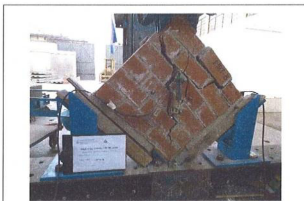
Figura 7 Ensayo de compresión diagonal
