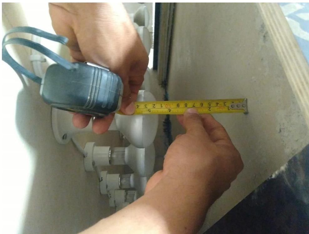
FOTO N°17: ANTES DE INICIAR EL ENSAYO, PONER EL PANEL DE FOTOS A 11CM DE LA CARA DEL MURETE, PUESTO QUE ES LA DISTANCIA QUE NOS DIO EL SOLARIMETRO EN DONDE SE SIMULA LA RADIACION DE 1000 W/M2.
