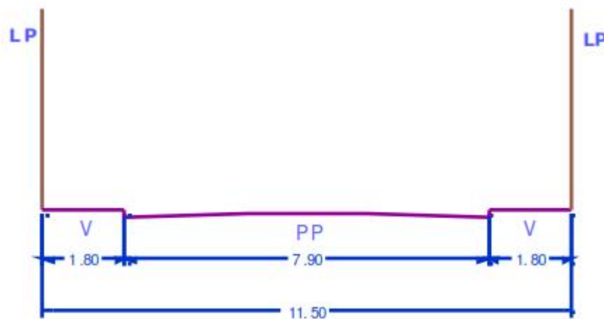
Figura 127 Sección típica vías comunes Fuente: Elaboración propia
