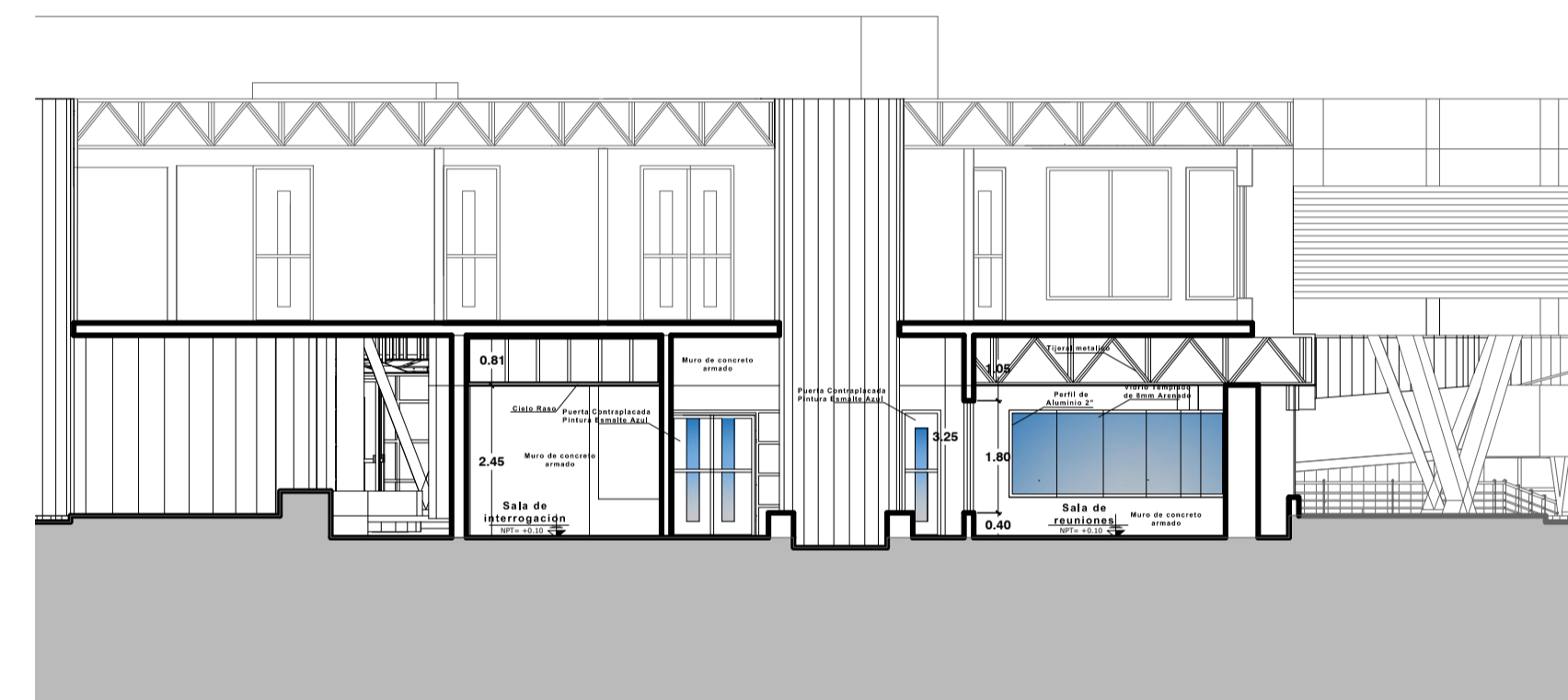
SECCION B-B CENTRO EMERGENCIA MUJER ESCALA 1/50
