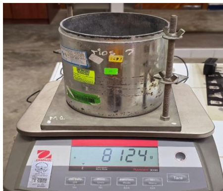
Figura 52 P.U. proporciones – Masa de recipiente
