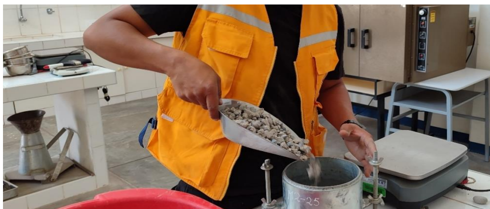
Figura 8 Peso Unitario – vertimiento del agregado en el molde
