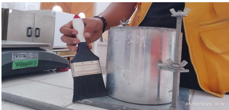
Figura 10 Peso Unitario – Limpieza de material excedente
