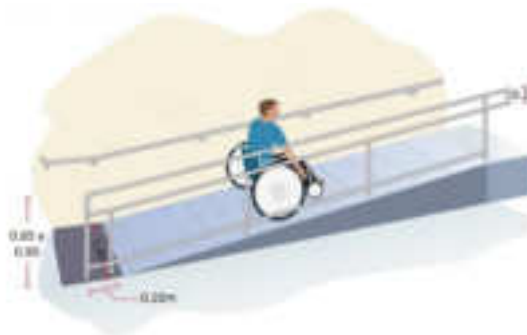
Barandas con doble pasamanos horizontal
